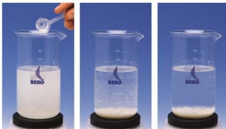
Figura 7. Formación de floculo (Unión mecánicamente las partículas en suspensión)
