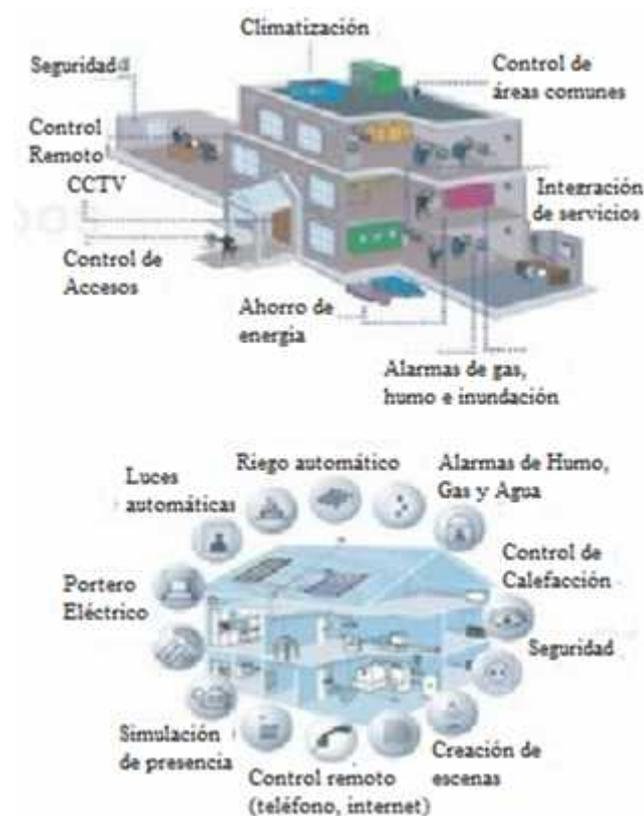
**Figura 3.3.** Esquema de un Sistema Domótico.
