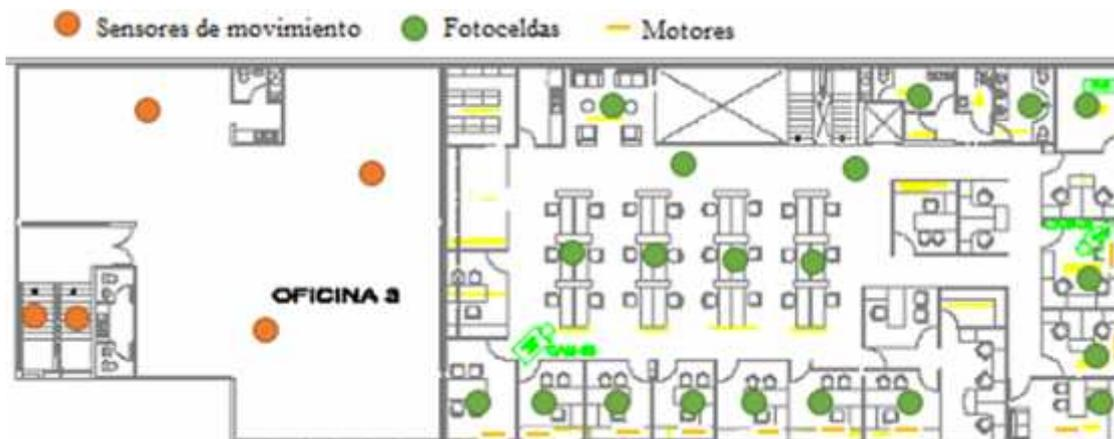
**Figura 6.3** Subsistema de Iluminación en la Primera Planta Alta del Área Comercial.
