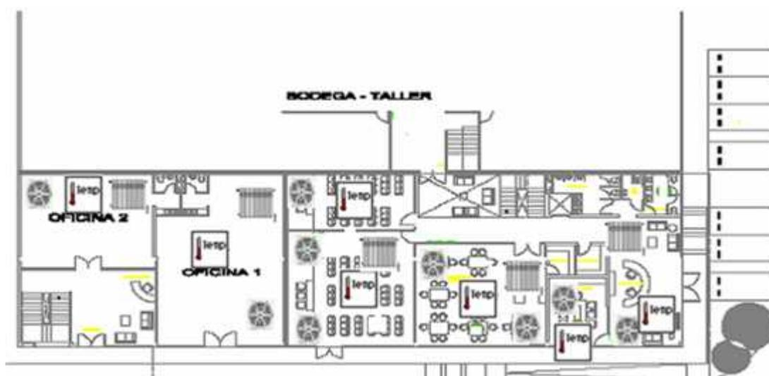
**Figura 6.8** Subsistema de Calefacción y Ventilación en la Planta Baja del Área Comercial
