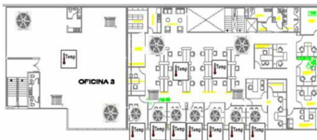
**Figura 6.9** Subsistema de Calefacción y Ventilación en la Primera Planta Alta del Área Comercial
