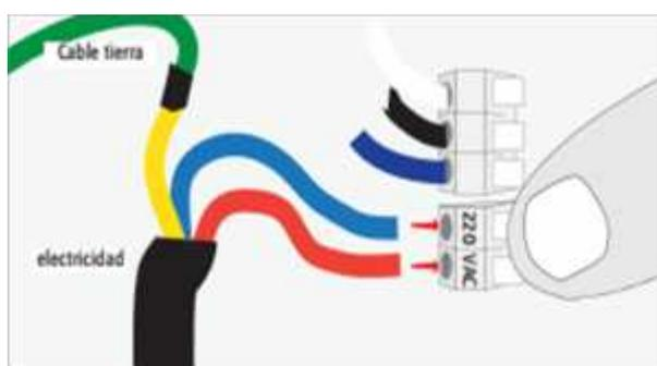
**Figura 2.11.** Conexión eléctrica del motor.
