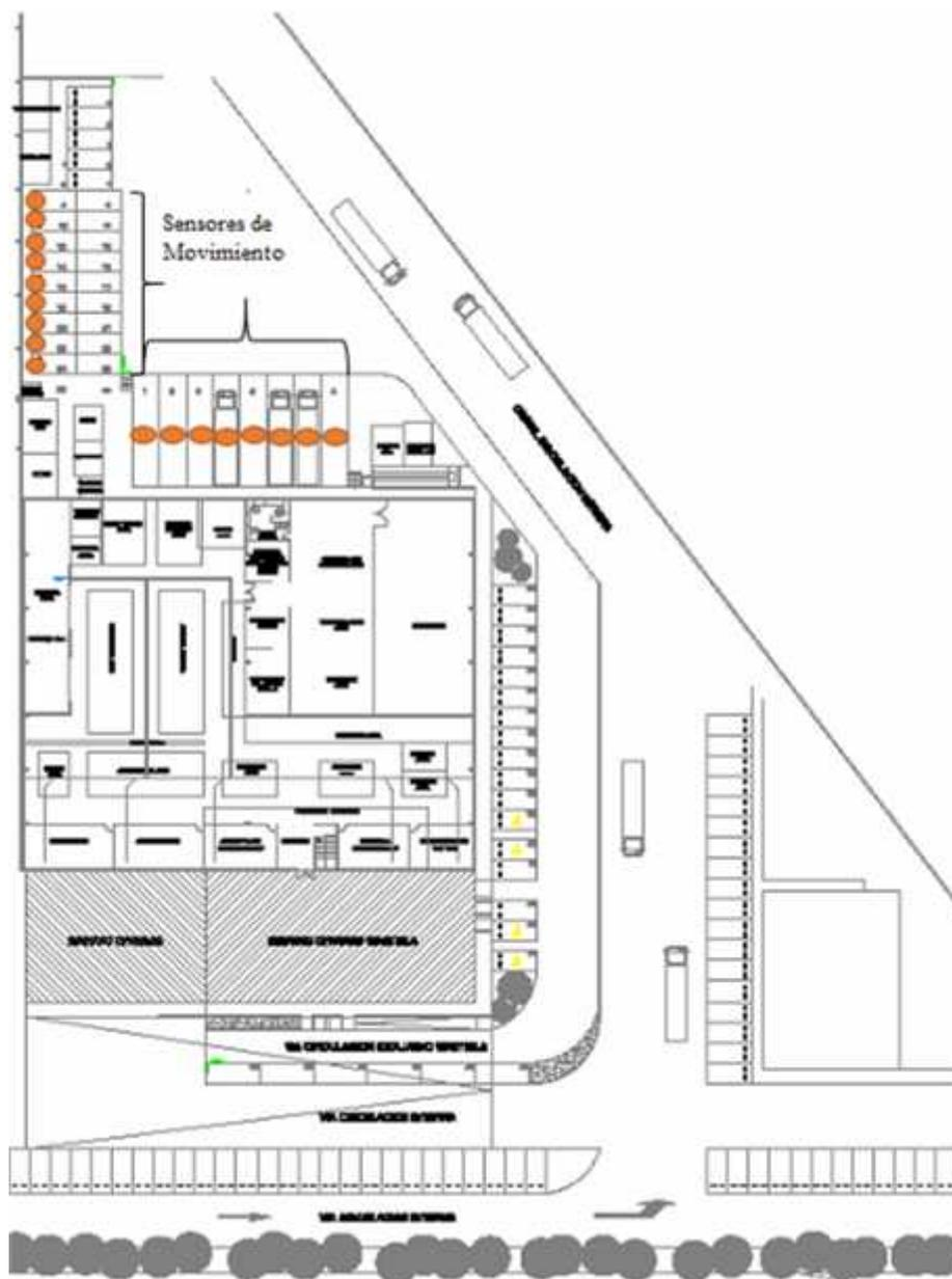
**Figura 6.1** Subsistema de iluminación para el Parqueadero
