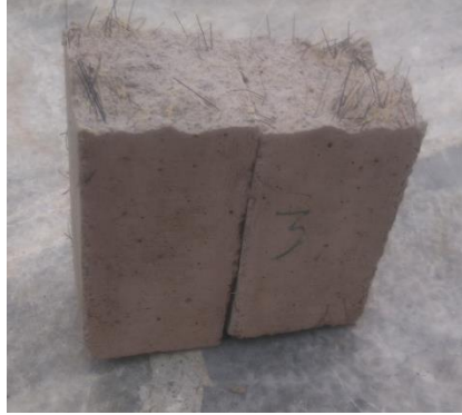
Figura 34. Probeta hecha con fibras de brocha para el ensayo de flexión.
