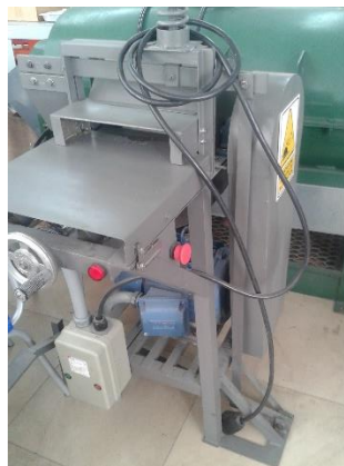
Figura 11. Desfibradora de hojas y seudotallo
