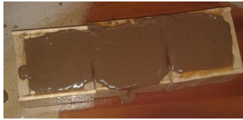
Figura 21. Llenado de moldes con material compuesto
