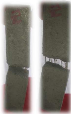
Figura 35. Probetas de ensayo a flexión conformadas por capas de fibras largas.
