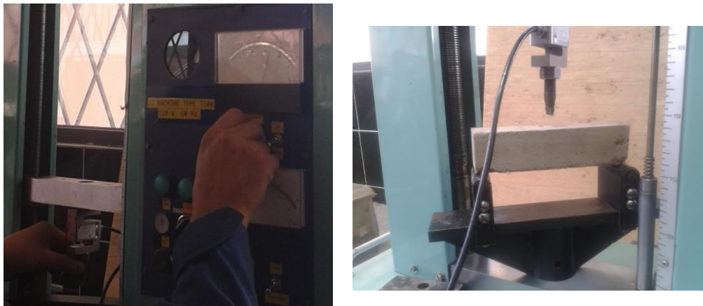
Figura 27. Desarrollo del ensayo de flexión en las probetas
