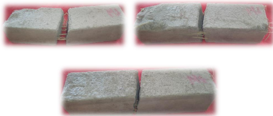
Figura 33. Probetas echas de capas de raquis de banano con fibras largas
