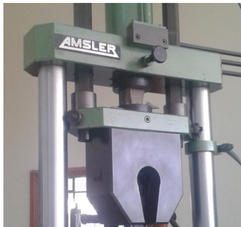
Figura 26. Forma de realizar el ensayo de compresión
