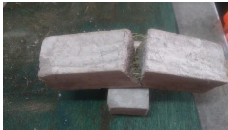
Figura 32. Probeta de ensayo a flexión con raquis de banano
