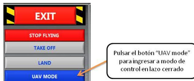
*Figura 77. Botón para la elección de modo UAV para el control en lazo cerrado*
