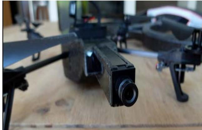
Fotografía 6. Cámara acoplada al AR.Drone 2.0
