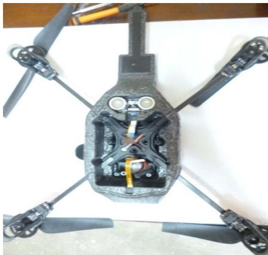
*Fotografía 3. Cuerpo o parte central, configuración forma X del AR.Drone 2.0*
