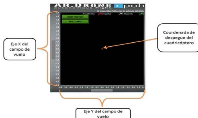
Figura 85. Zona de visualización de desplazamientos del cuadricóptero
