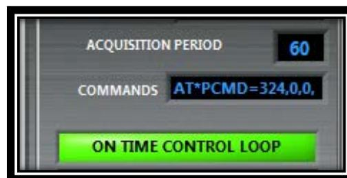
Figura 72. Tiempo de muestreo e indicador óptimo/fallo de lazo de control
