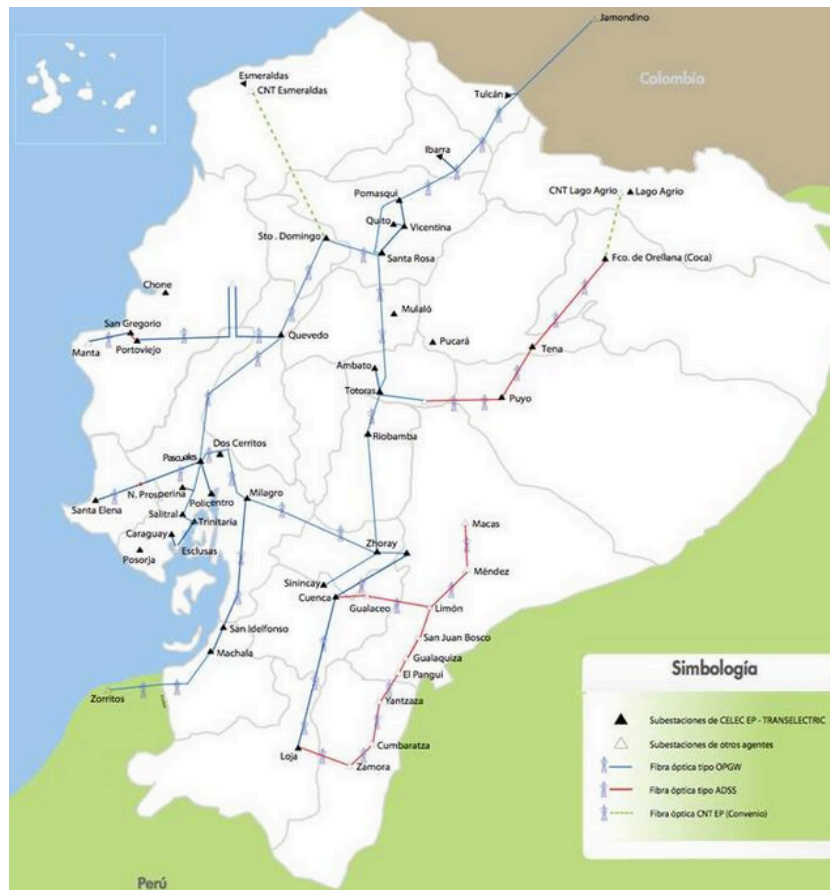
Figura 3.17 Mapa de la Red Nacional de Fibra Óptica de CELEC EP - TRANSELECTRIC
