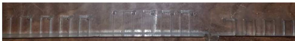
Figura 164.- Prueba de corte en acrílico. (Velocidad constante – PWM variable)
