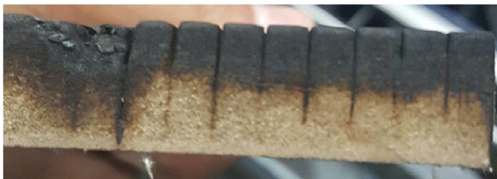
Figura 170.- Corte transversal para medir profundidades de corte laser en MDF.
