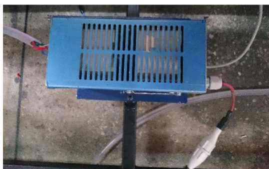
Figura 150.- Fuente de poder del tubo láser.
