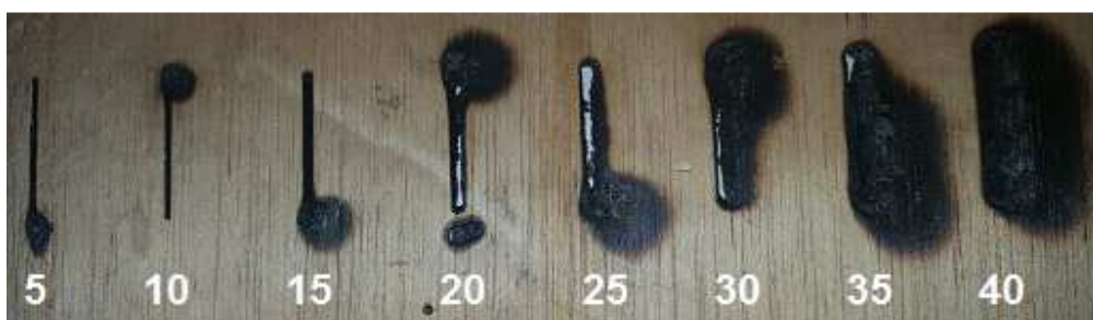
Figura 167.- Pruebas de altura de cabezal en MDF (Medidas en mm)
