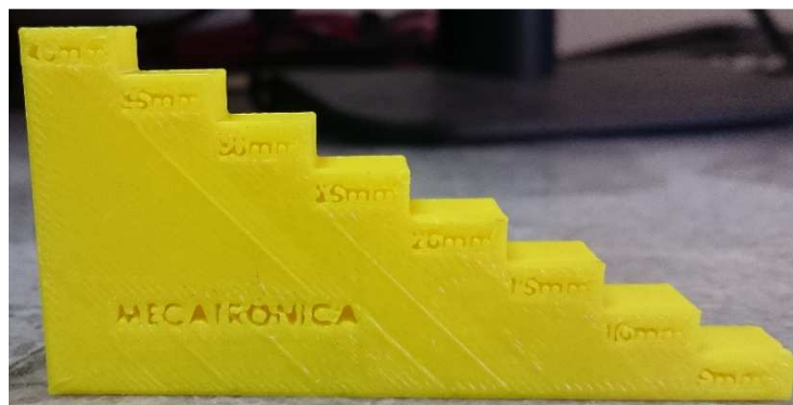
Figura 158.- Galgas para fijar altura del cabezal de corte.
