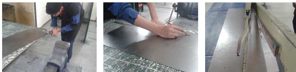
Figura 132.- Manufactura de Paneles exteriores
