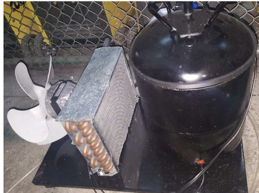
Figura 87.- Sistema de refrigeración implementado.
