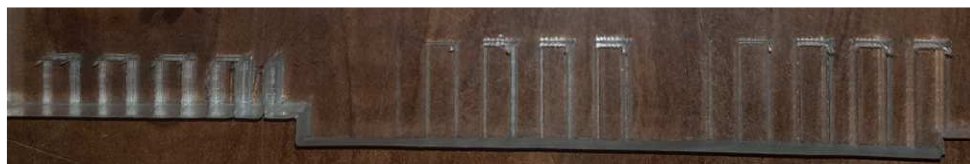
Figura 162.- Prueba de corte en acrílico (PWM constante – Velocidad variable)
