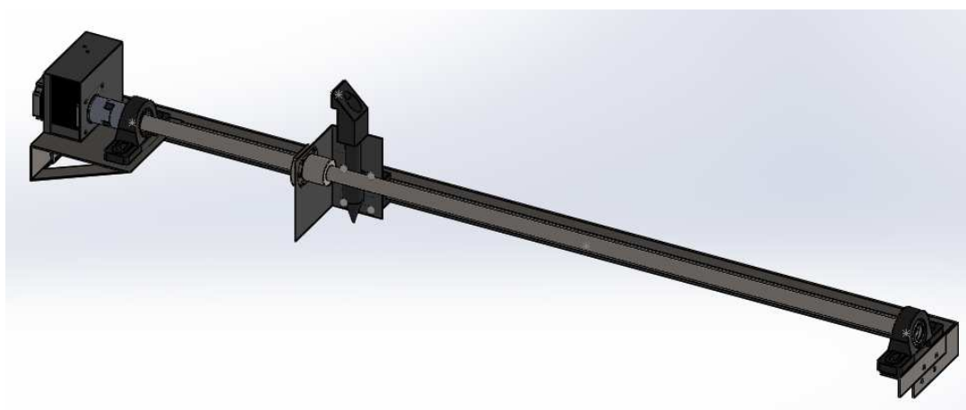
Figura 36.- Sistema de movimiento del eje X
