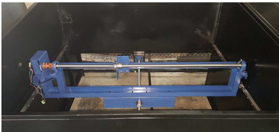
Figura 140.- Ejes de movimiento instalados.
