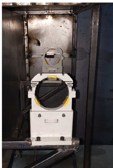
Figura 151.- Soportes del tubo láser.
