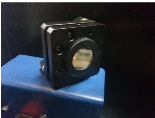
Figura 22.- Fotografía del soporte para espejos.
