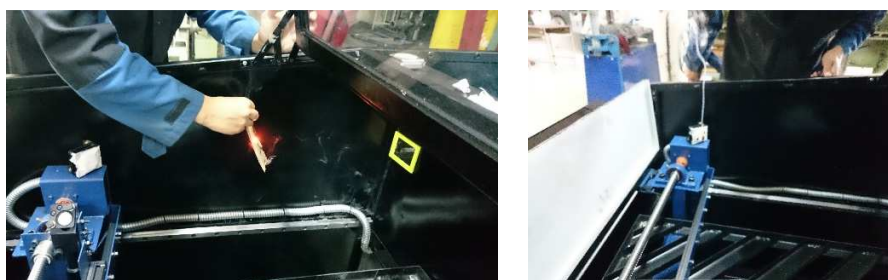
Figura 157.- Calibración de haz de luz láser.
