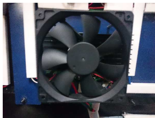
Figura 145.- Ventilador y drivers de motores.
