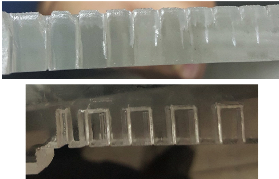
Figura 161.- Cortes en acrílico con potencia constante, velocidad variable (vista frontal y superior)
