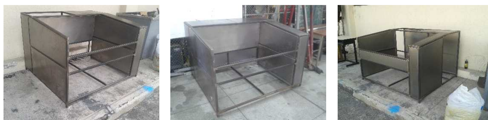
Figura 133.- Ubicación de paneles en la estructura
