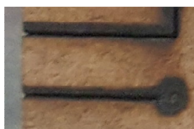
Figura 168.- Corte con altura de cabezal de 8mm.
