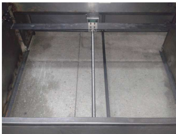
Figura 138.- Tornillo de bolas instalado.
