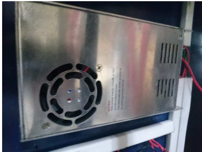
Figura 143.- Fuente de poder para motores.
