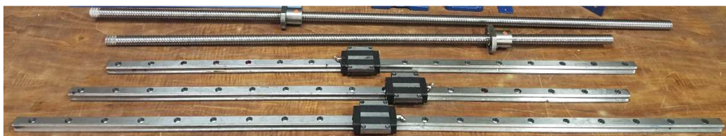
Figura 136.- Tornillos de bolas y guías lineales.
