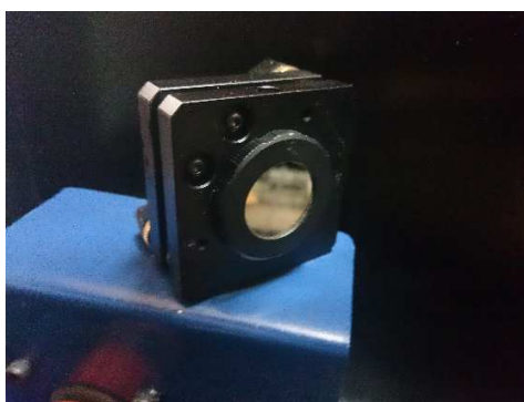
Figura 152.- Soportes y espejos instalados.
