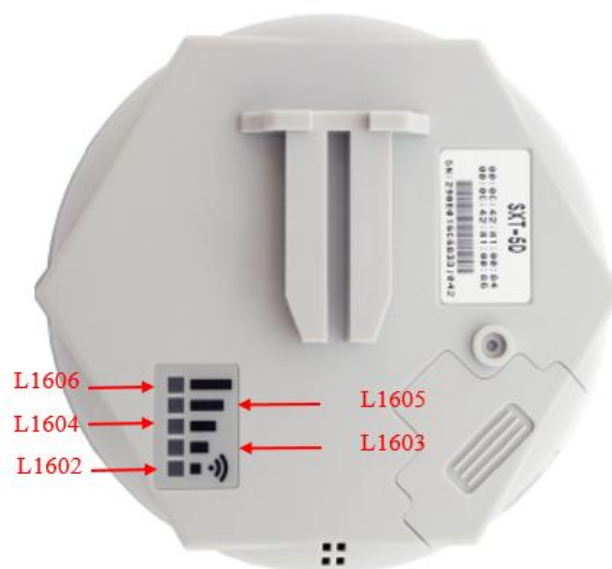
Figura 26. Indicadores LED de la potencia de la señal inalámbrica
