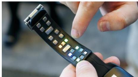
(b) Sensores adicionales de temperatura y frecuencia cardíaca.
