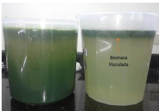
**Figura 18** Cosecha de biomasa mediante floculación
