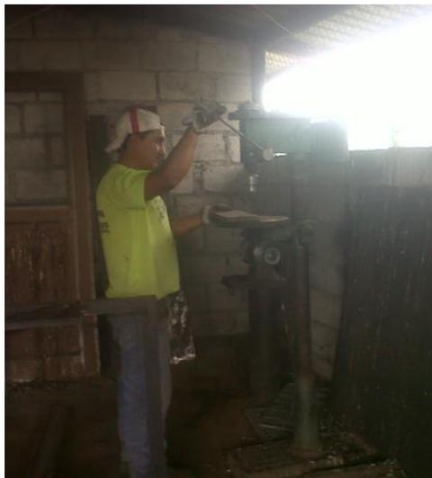
Figura 81 Perforado de agujeros para sujeción de llantas
