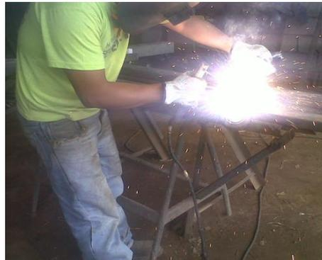
Figura 89 Soldadura de eje
