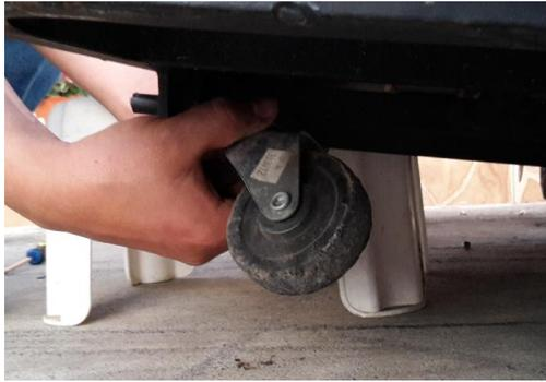
Figura 122 Montaje de ruedas.
