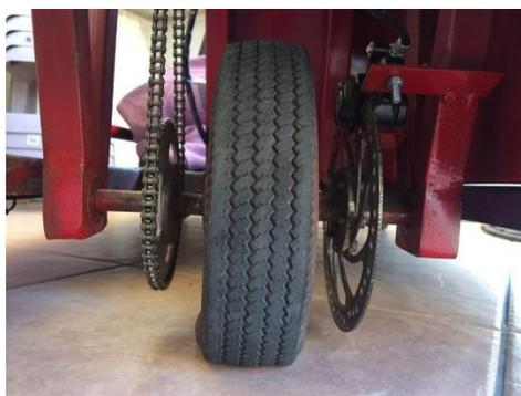
Figura 110 Montaje del eje de transmisión.
