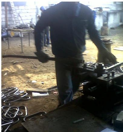
Figura 93 Doblado de tubo cuadrado ASTM A36.
