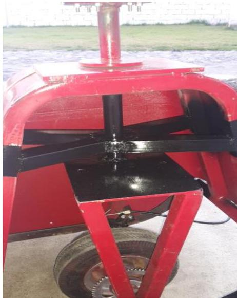
Figura 125 Montaje del sistema de dirección.
