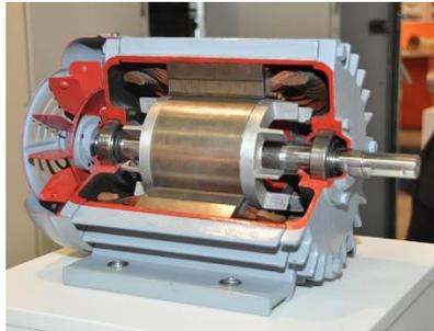
Figura 24 Motor de imán permanente.
