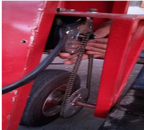
Figura 111 Montaje de cadena.
