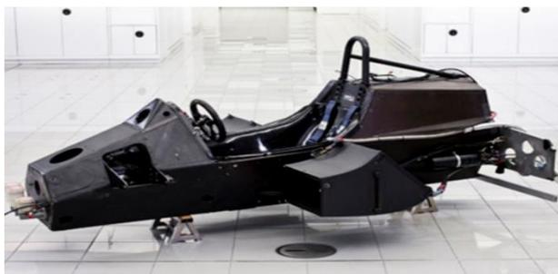
Figura 16 Estructura monocasco en Formula 1.
