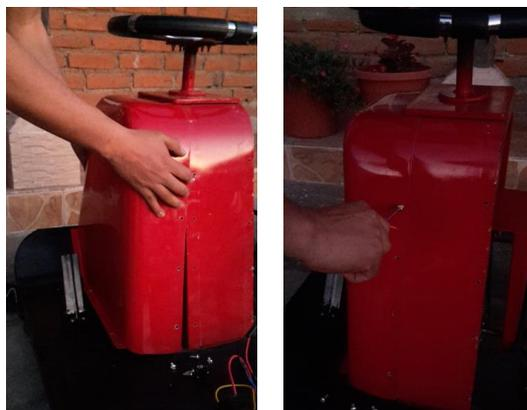
Figura 128 Montaje de la cubierta del sistema de dirección.
