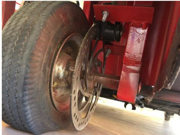
Figura 131 Montaje del freno de disco.
