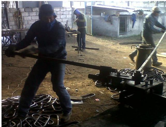
Figura 72 Doblaje de tubo principal del chasis
