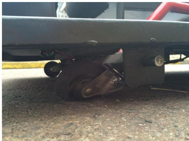
Figura 145 Desgaste de las ruedas posteriores
