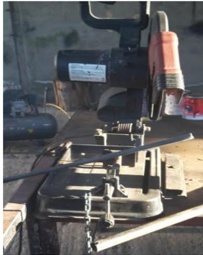
Figura 86 Corte del eje en acero 1045.
