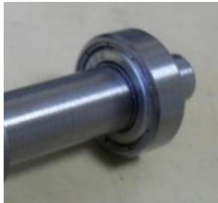
Figura 103 Montaje de rodamientos SKF 6302.
