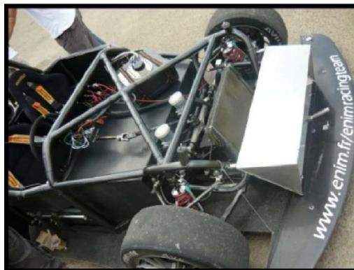
Figura 17 Estructura Tubular.
