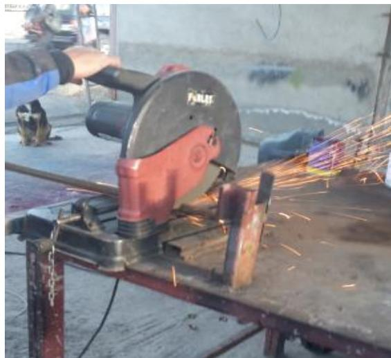
Figura 83 Corte de Tubo redondo ASTM A36.
