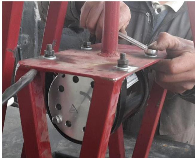
Figura 130 Montaje del motor.
