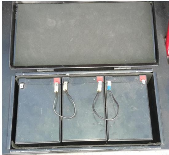
Figura 135 Baterías conectadas en serie.
