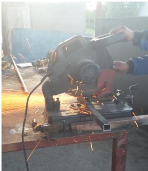
Figura 80 Corte del cuerpo del freno de mano
