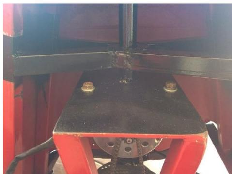
Figura 102 Unión de barra de dirección con la placa.
