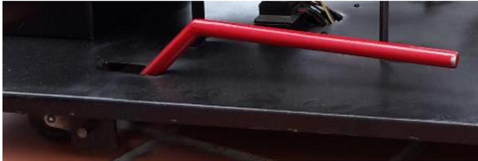
Figura 123 Montaje del sistema de freno de mano.
