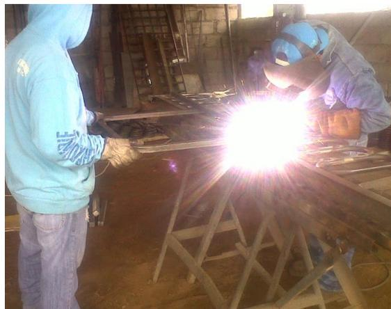
Figura 75 Soldadura de partes laterales del chasis
