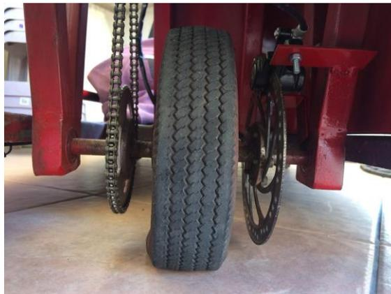
Figura 105 Eje de transmisión con sus componentes instalados.
