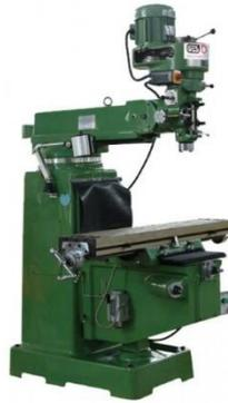
Figura 67 Fresadora vertical
