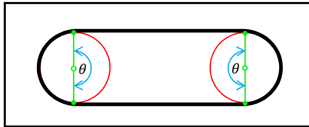
Figura 46. Ángulos de contacto en la banda transportadora
