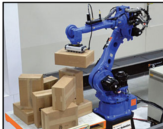
Figura 6. Brazo Mecánico Industrial para el Traslado de Cajas
