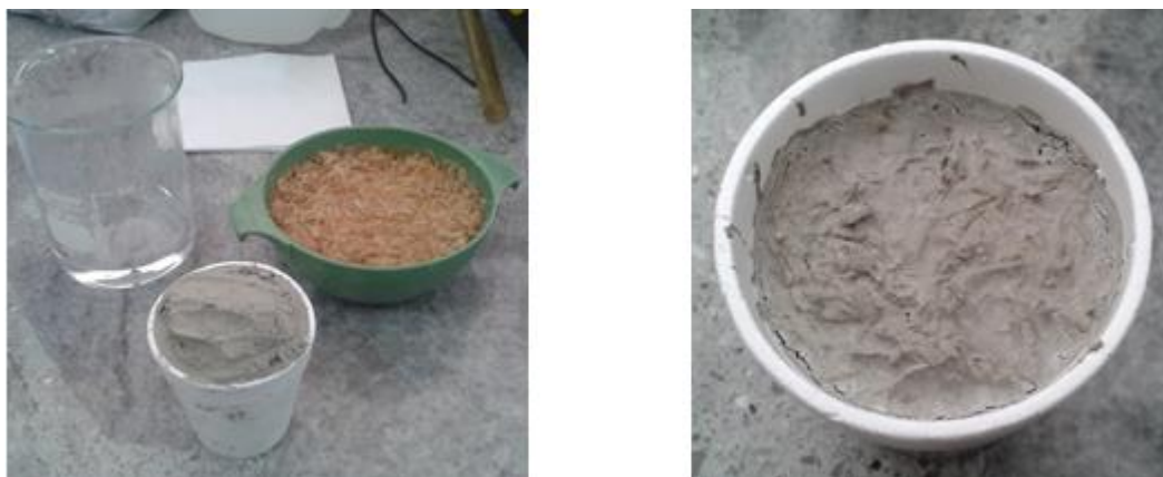
Figura 71. Pasta con guadúa húmeda y cemento portland puzolánico tipo IP
