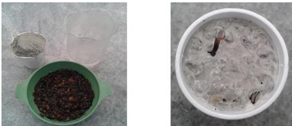
Figura 66. Pasta con cascarilla de café húmeda y cemento portland
