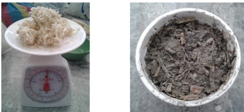
Figura 68. Pasta con bagazo de caña húmedo y cemento portland puzolánico tipo IP
