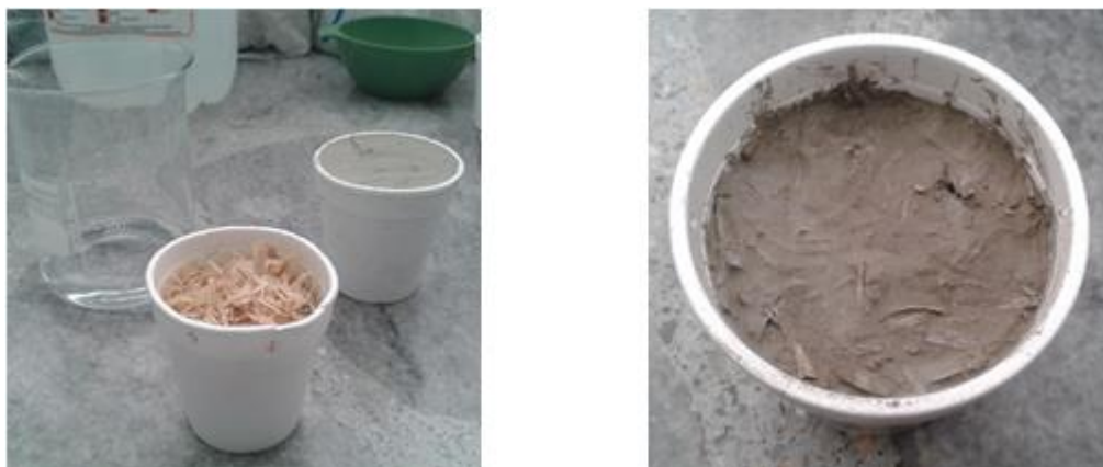
Figura 70. Pasta con guadúa seca y cemento portland puzolánico tipo IP
