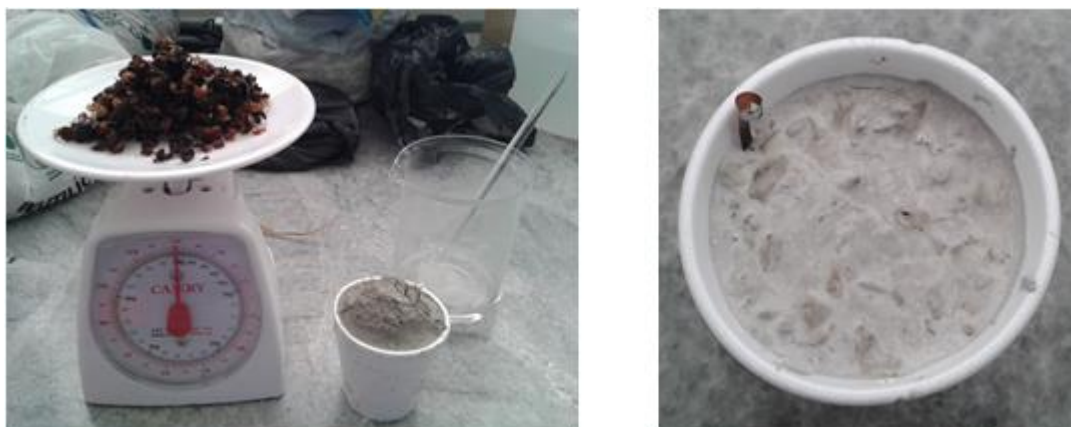
Figura 65. Pasta con cascarilla de café húmeda y cemento portland puzolánico tipo IP
