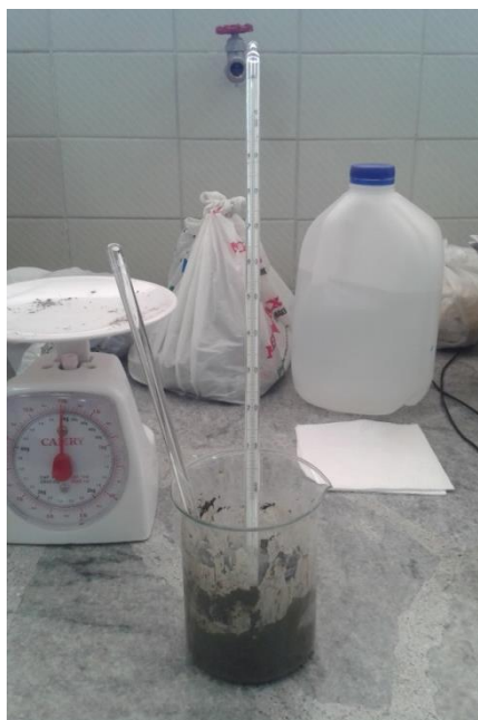
Figura 49. Medición de la pasta de cemento con el termómetro de mercurio
