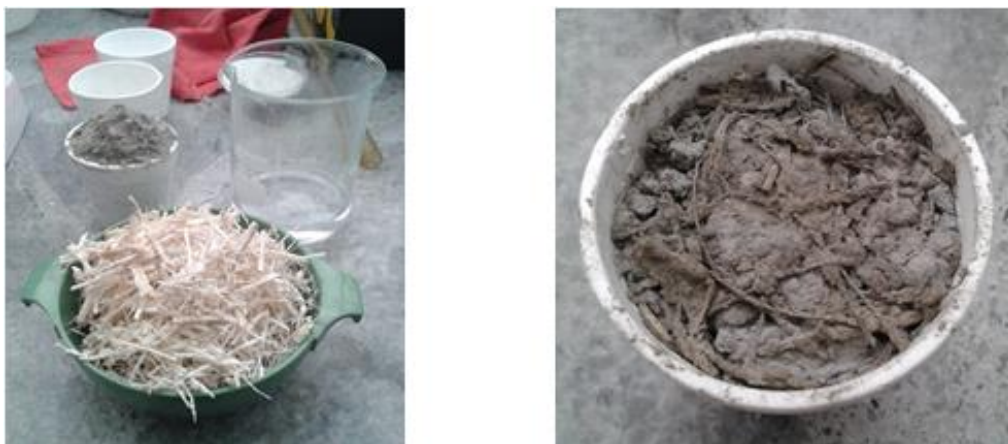
Figura 67. Pasta con bagazo de caña seco y cemento portland puzolánico tipo IP
