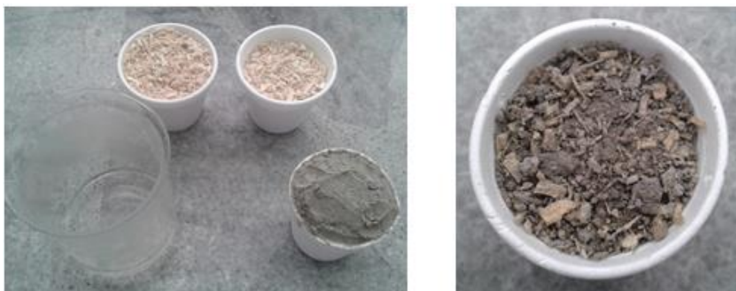
Figura 76. Pasta con cemento portland y adición de más bagazo de caña seco en la mezcla
