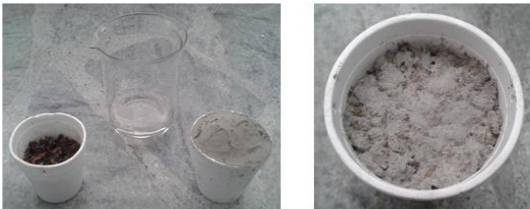
Figura 61. Pasta con cascarilla de cacao seca y cemento portland puzolánico tipo IP
