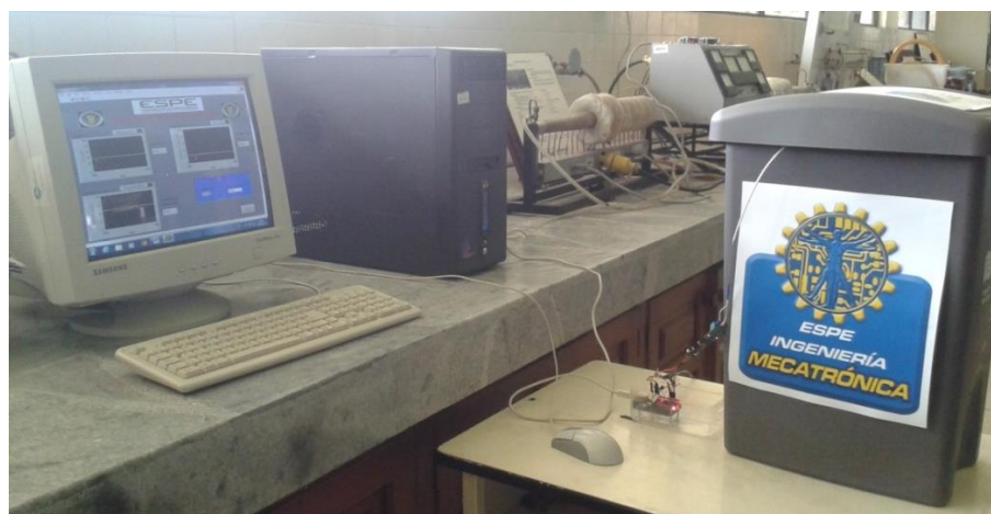
Figura 34. Calorímetro para medir temperatura en un sistema cuasi adiabático
