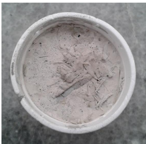
Figura 73. Pasta con guadúa húmeda y cemento portland puzolánico tipo IP con adición de más agua a la mezcla
