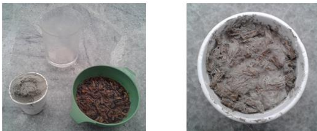
Figura 59. Pasta con raquis de plátano húmedo y cemento portland puzolánico tipo IP
