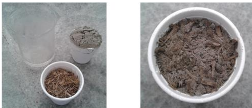
Figura 58. Pasta con raquis de plátano seco y cemento portland puzolánico tipo IP
