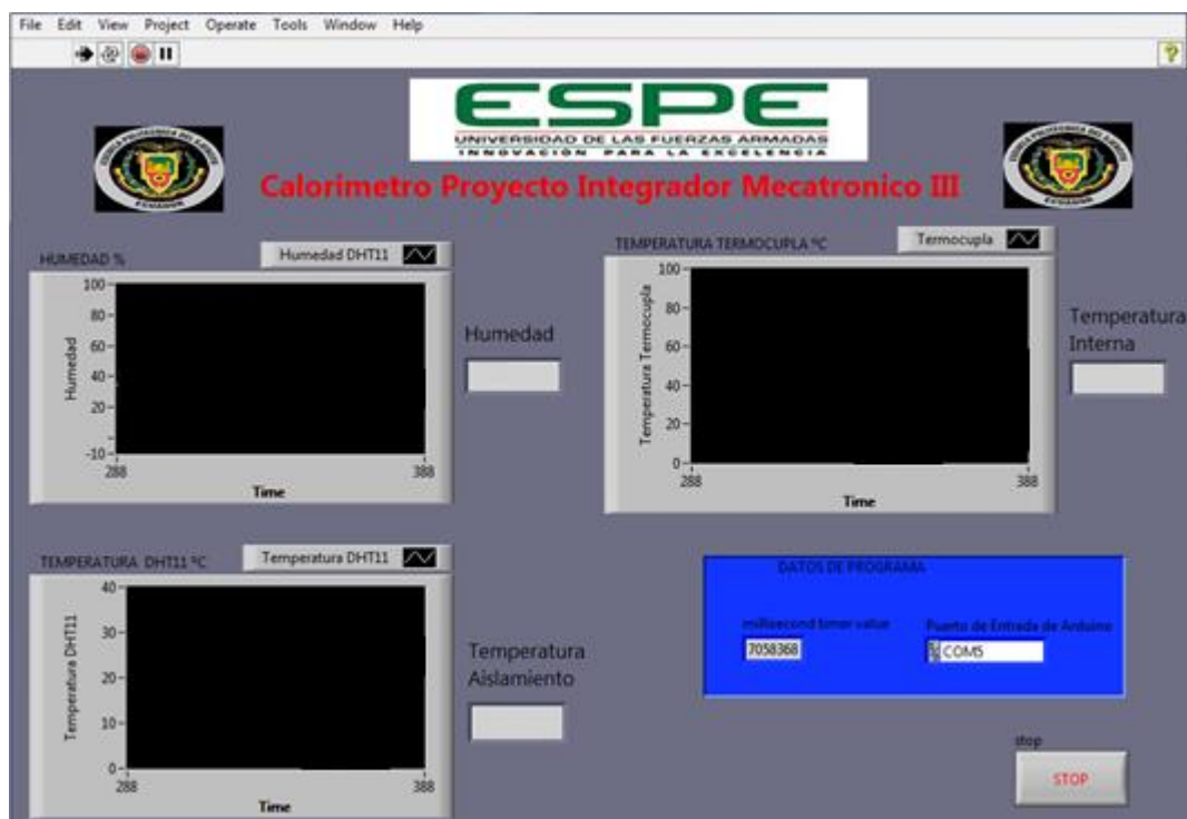
Figura 45. Interfaz HMI, para la observación de parámetros e interacción con el usuario
