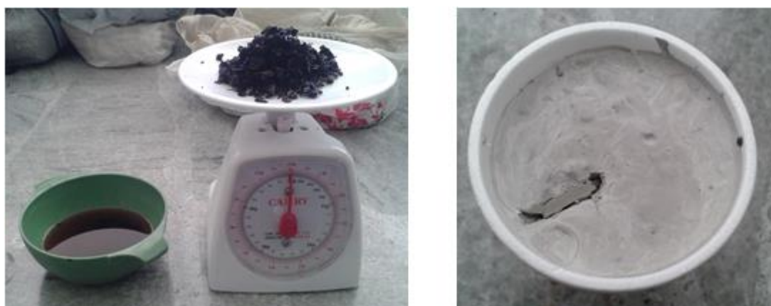
Figura 62. Pasta con cascarilla de cacao húmeda y cemento portland puzolánico tipo IP
