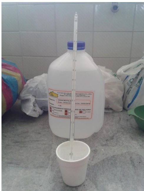
Figura 47. Medición del agua destilada con termómetro de mercurio
