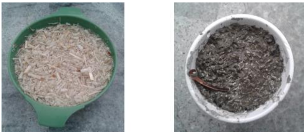
Figura 69. Pasta con bagazo de caña húmedo y cemento portland
