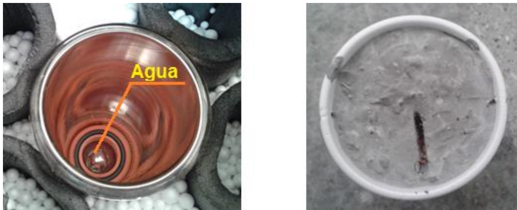
Figura 63. Pasta con cascarilla de cacao húmeda y cemento portland
