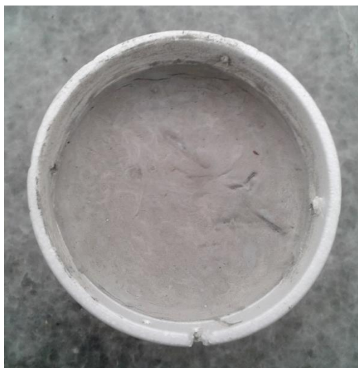
Figura 75. Pasta con cemento portland puzolánico tipo IP y disminución de guadúa seca en la mezcla
