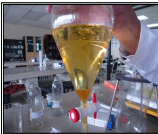
Fuente: Grupo de investigación Figura 3.8 Embudo de decantación
