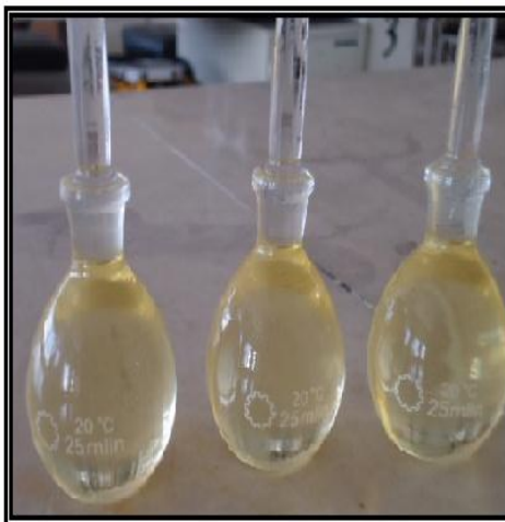
Fuente: Grupo de investigación Figura 6.11 Picnómetros llenos de biodiesel
