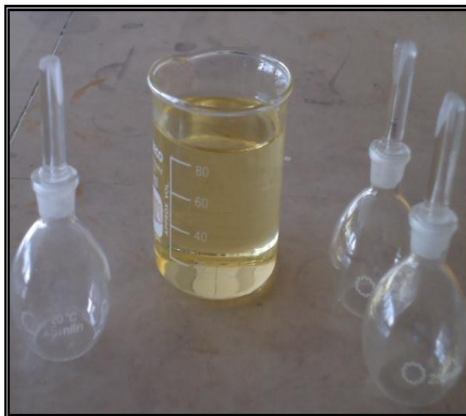
Fuente: Grupo de investigación Figura 6.9 Picnómetros lavados y secos
