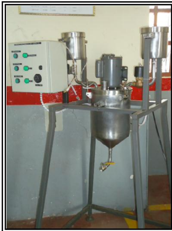
Fuente: Grupo de investigación Figura 4.47 Reactor Automatizado para producir biodiesel
