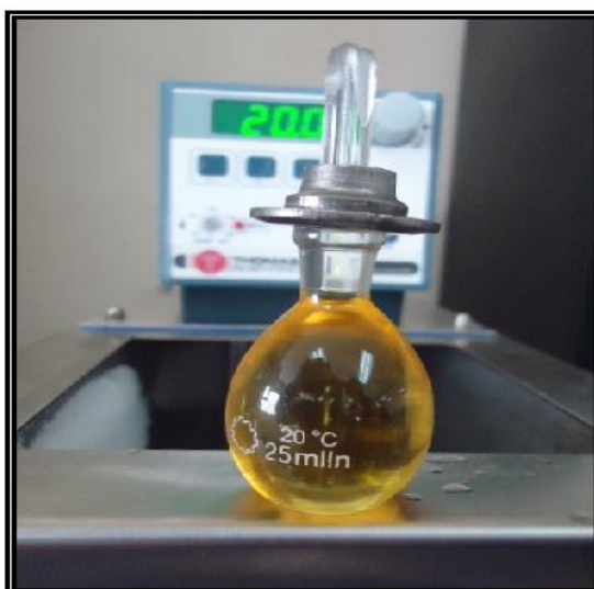
Fuente: Grupo de investigación Figura 6.13 Retirando el picnómetro del baño María
