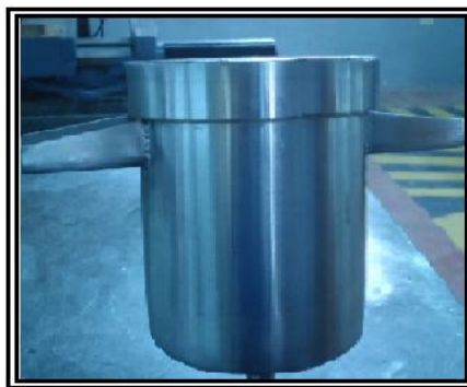
Fuente: Grupo de investigación Figura 4.40 Depósito de metóxido.
