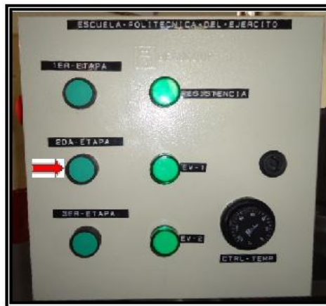
Fuente: Grupo de investigación Figura 6.6 Pulsador de inicio de la segunda etapa
