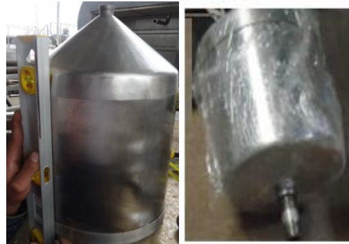
Figura 6. Depósitos de aceite y metóxido
