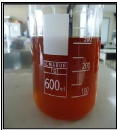
Fuente: Grupo de Investigación Figura 3.1 Aceite vegetal usado luego de ser tratado
