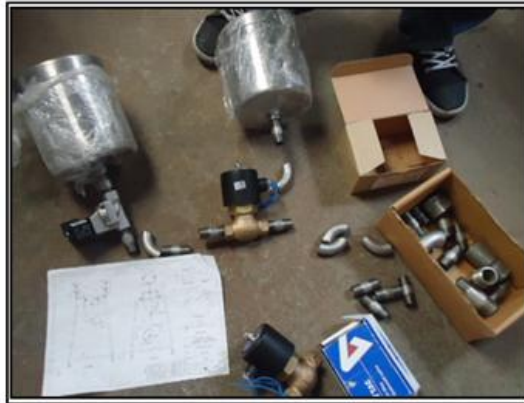
Fuente: Grupo de investigación Figura 4.45 Accesorios y tubería para acoplar a los depósitos y electroválvulas
