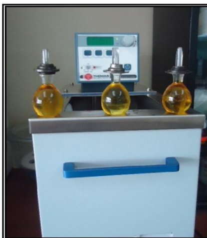
Fuente: Grupo de investigación Figura 6.12 Picnómetros llenos antes de ser sumergidos
