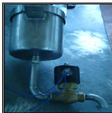
Fuente: Grupo de investigación Figura 4.41 Depósito de agua acoplado a la electroválvula
