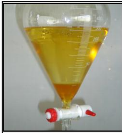
Fuente: Grupo de investigación Figura 3.9 Separación glicerina y biodiesel
