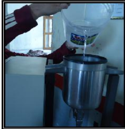
Fuente: Grupo de investigación Figura 6.2 Carga del contenedor de metóxido
