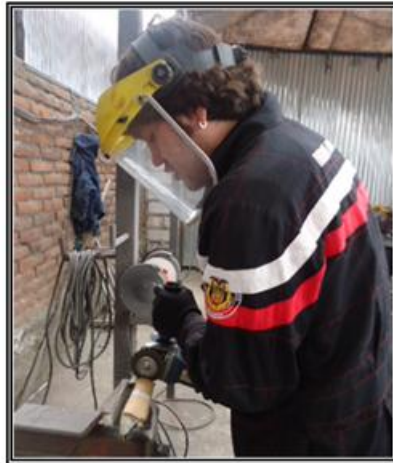
Fuente: Grupo de investigación Figura 4.42 Corte del eje y la platina.
