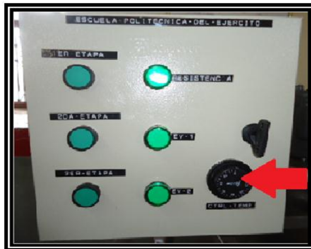
Fuente: Grupo de investigación Figura 5.6 Perilla de control de la temperatura
