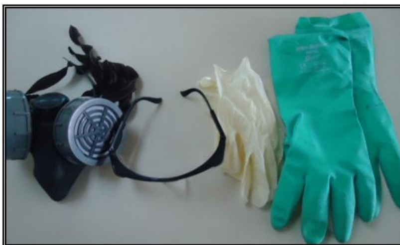
Fuente: Grupo de investigación Figura 2.9 Elementos de protección (mascarilla, gafas protectoras y guantes)
