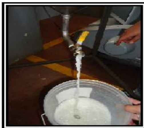
Fuente: Grupo de investigación Figura 6.7 Decantación de agua con impurezas
