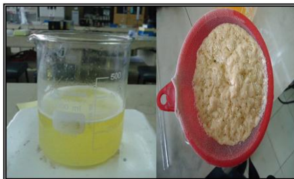
Fuente: grupo de investigación Figura 3.11 Lavado y filtrado del biodiesel
