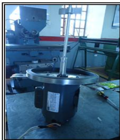
Fuente: Grupo de investigación Figura 4.46 Motor – agitador ensamblado.
