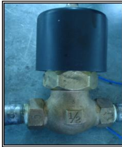
Fuente: Grupo de investigación Figura 4.15 Válvula solenoide instalada en el reactor para controlar el ingreso de agua
