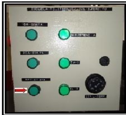
Fuente: Grupo de investigación Figura 6.8 Pulsador de inicio de la tercera etapa
