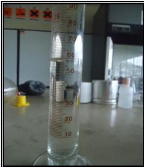
Fuente: Grupo de investigación Figura 3.3 Medición del volumen de metanol
