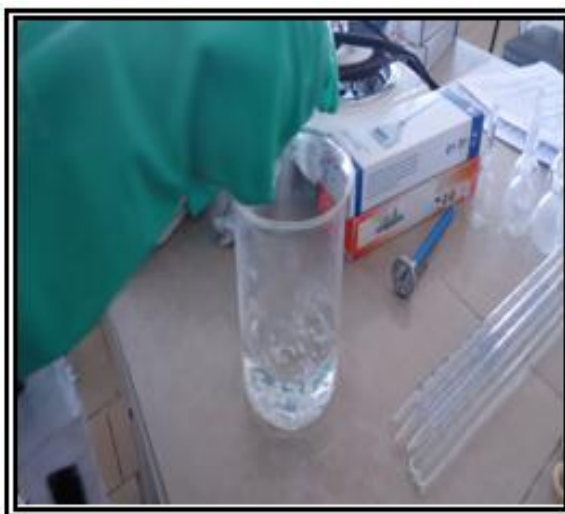
Fuente: Grupo de investigación Figura 3.4 Solución de KOH y metanol
