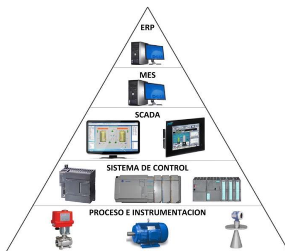
Figura 13. Pirámide de la automatización.
