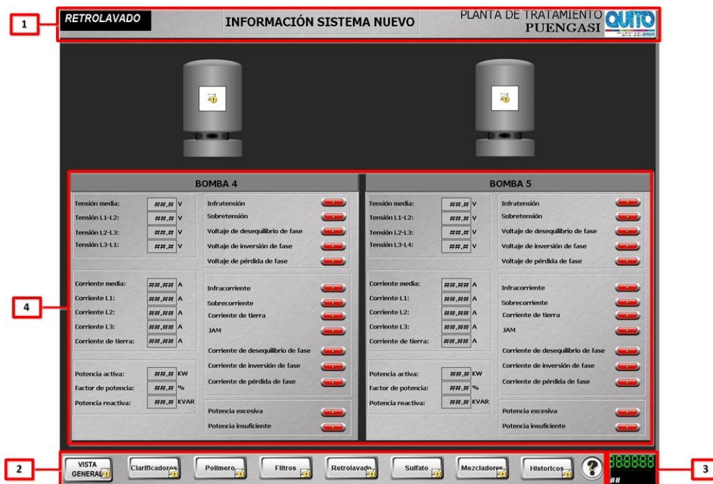
Figura 91. Pantalla de información de las bombas de Retrolavado.
