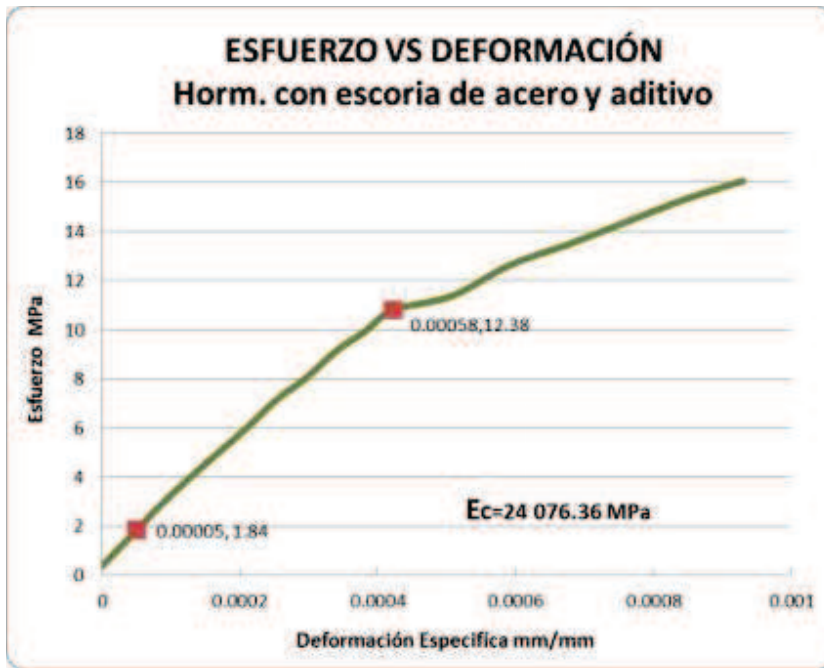
Cuadro 46. Resumen de resultados del módulo de elasticidad del H.C, H.E y H.E.A.
