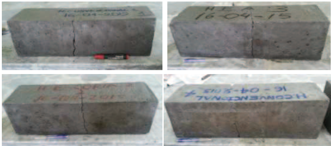
Figura 47. Fractura de vigas en el tercio medio de la luz libre de las mismas.
