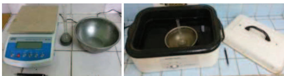
Figura 22. Equipo para realizar el ensayo ASTM C 188.
