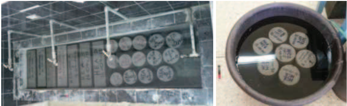
Figura 42. Curado final de especímenes: cilindros y vigas.
