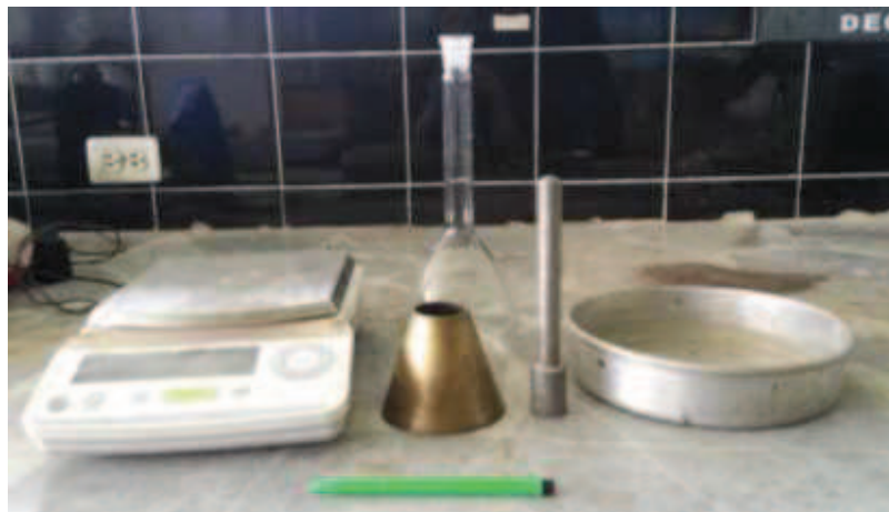
Figura 16. Equipo para realizar el ensayo ASTM C 128.
