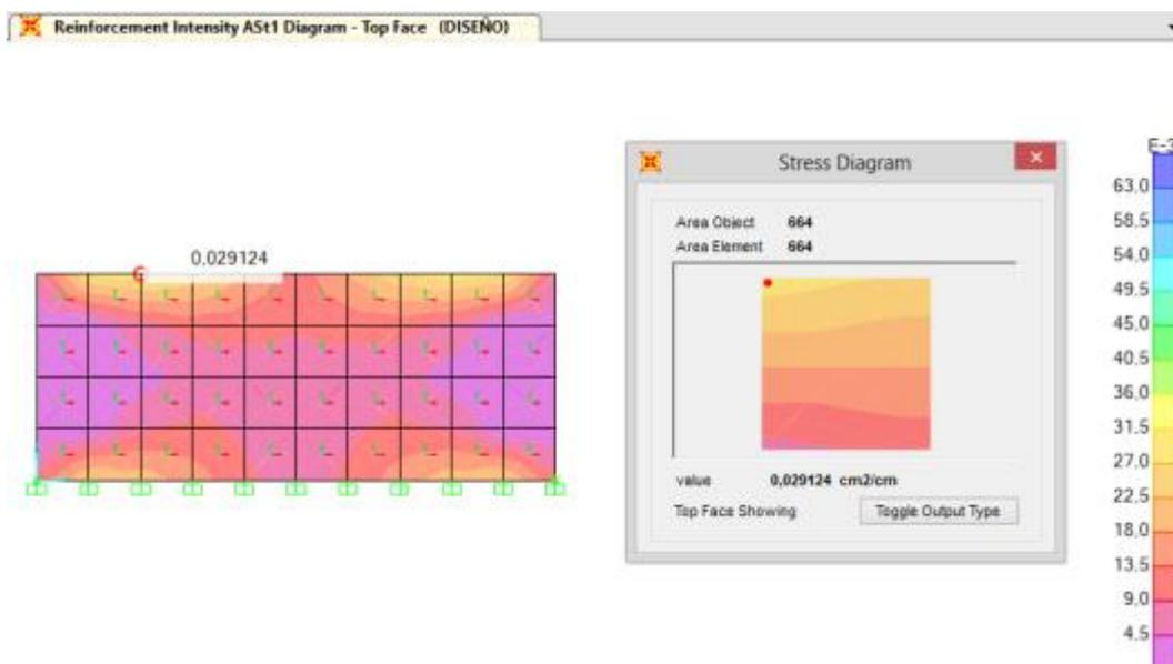
Figura 78.- Armadura Transversal en Paredes (5m)
