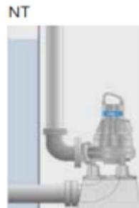
Figura 92.- Instalación vertical permanente en pozo seco en línea
