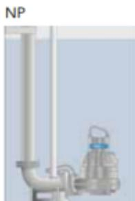
Figura 90.- Instalación semipermanente en pozo húmedo
