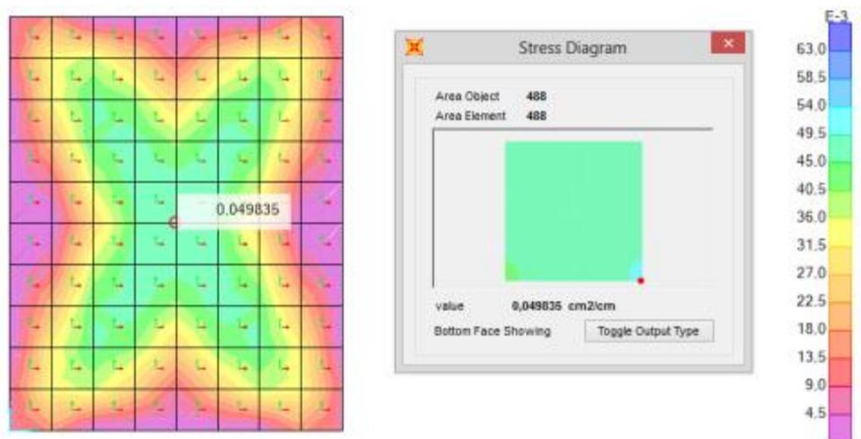
Figura 75.- Armadura Longitudinal en cara inferior (Losa de fondo y de tapa)
