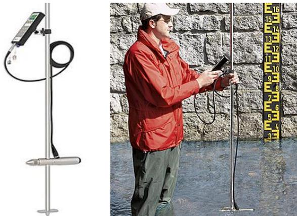
Figura 104.- Velocímetro de flujo acústico y digital
