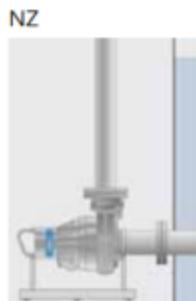
Figura 93.- Instalación horizontal permanente en pozo seco e en línea
