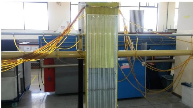
Figura 114.- Tablero para medición de pérdidas de altura piezométrica
