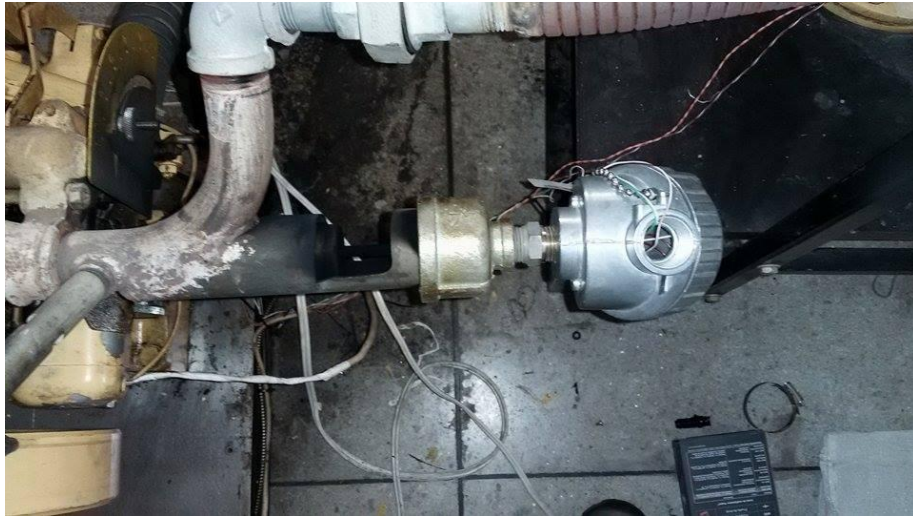
Figura 3.4. Instalación PT100 en tubo de escape
