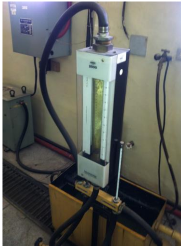
Figura 2.22. Sistema de refrigeración del banco de pruebas.
