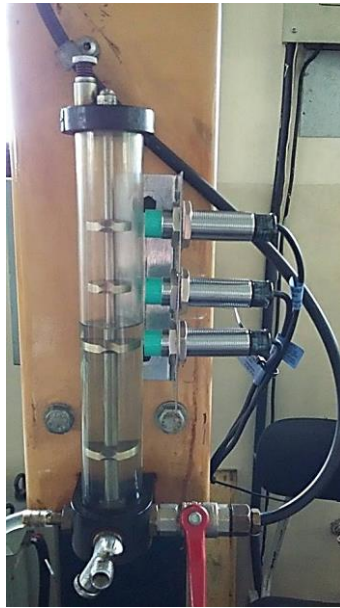
Figura 3.2. Instalación sensores capacitivos para volumen de gasolina
