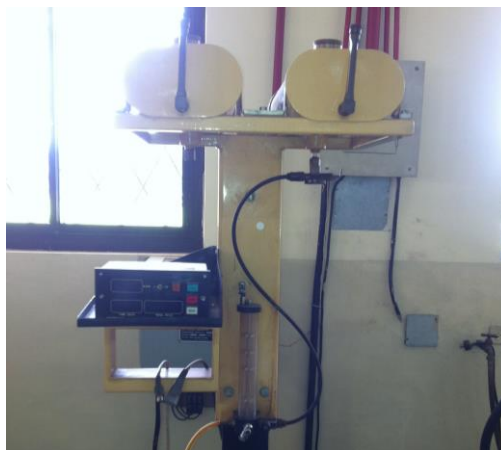
Figura 2.19. Sistema de suministro de combustible
