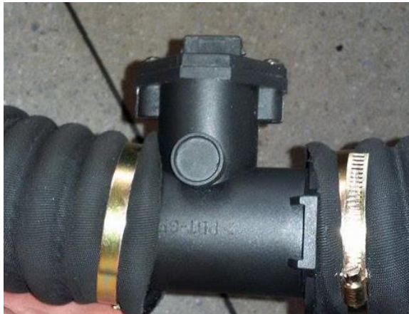
Figura 3.8. Instalación sensor MAF
