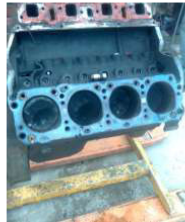
Figura 73, 74, 75, 76, 77 Desmontaje De La Culata Del Motor
