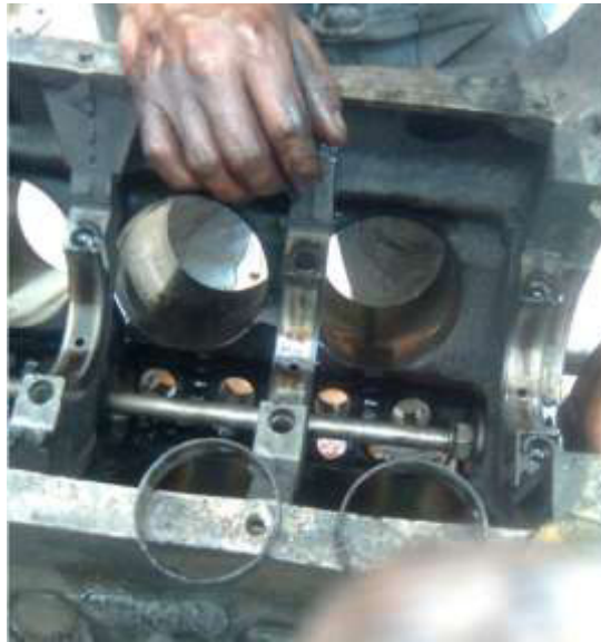
Figura 89 Bloque De Cilindros “Antes De La Reparación”
