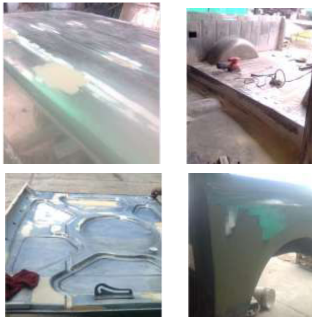
Figura 163 A La 166 Masillado En Lugares De Difícil Acceso.
