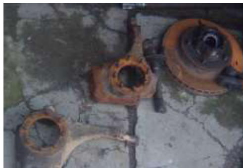
Figura 135, 136 Sistema De Frenos “Disco Y Tambor”
