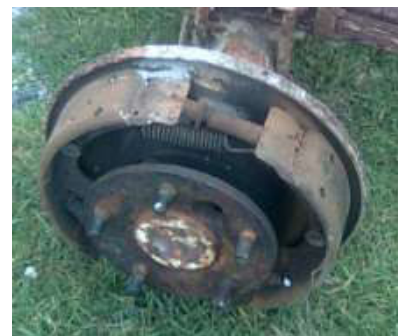
Figura 135, 136 Sistema De Frenos “Disco Y Tambor”
