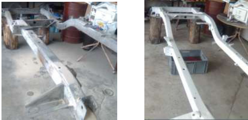
Figura 183, 184 Trabajos De Pintura Chasis
