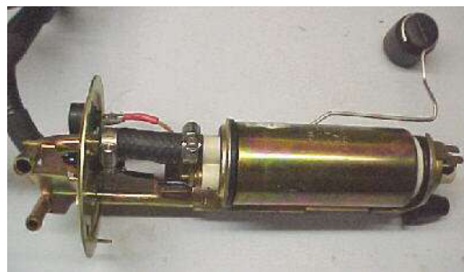
Bomba tipo interna (dentro del tanque de combustible)
