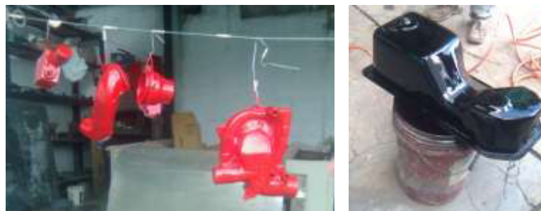
Figura 173, 174 Acabado Final Del Trabajo De Pintado Del Motor.
