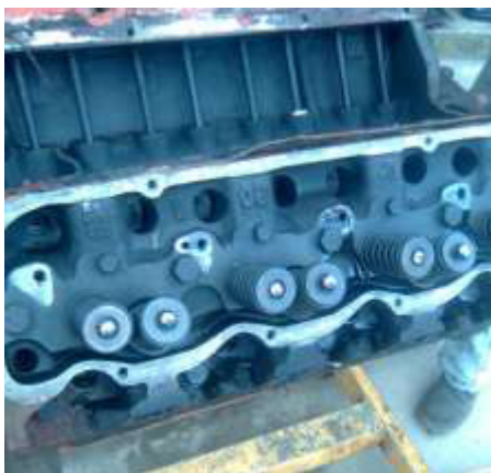
Figura 73, 74, 75, 76, 77 Desmontaje De La Culata Del Motor
