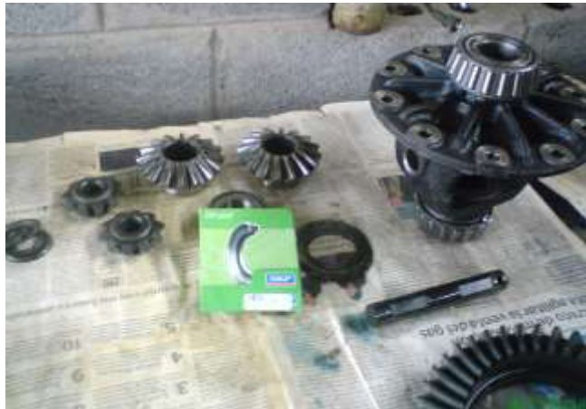
Figura 126 Proceso De Overhaul De Los Diferenciales
