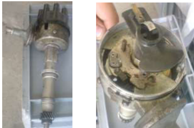
Figura 115, 116 Distribuidor y Rotor
