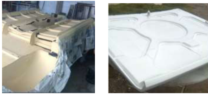
Figura 185 Y 186 Trabajos De Pintura De La Carrocería.
