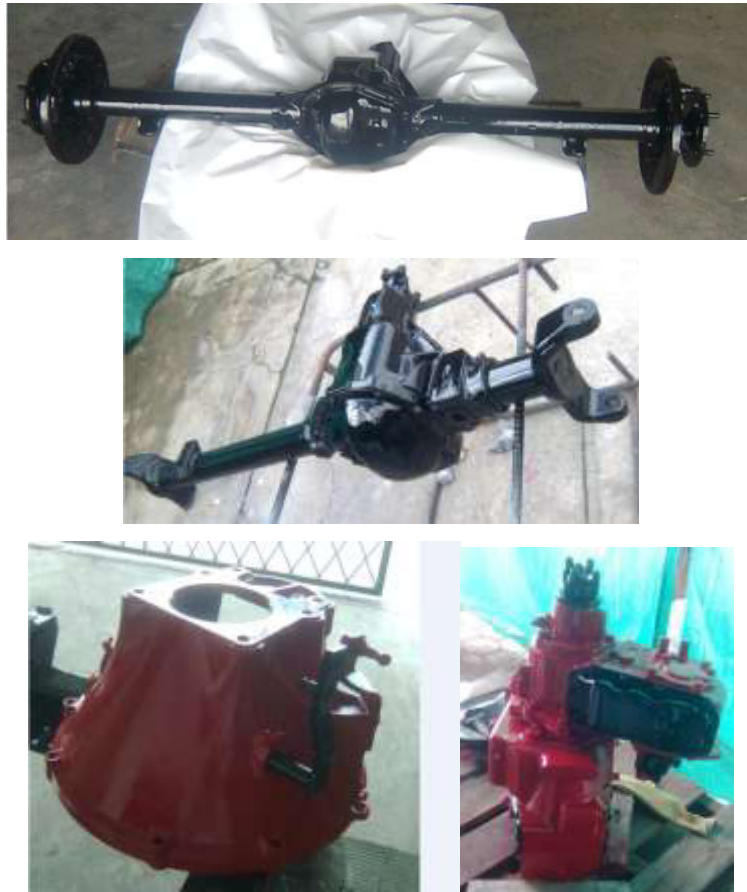
Figura 179 A La 182. Acabado Final Del Trabajo De Pintado De Diferencial “Delantero, Trasero”, Caja De Cambios, Caja De Transferencia.
