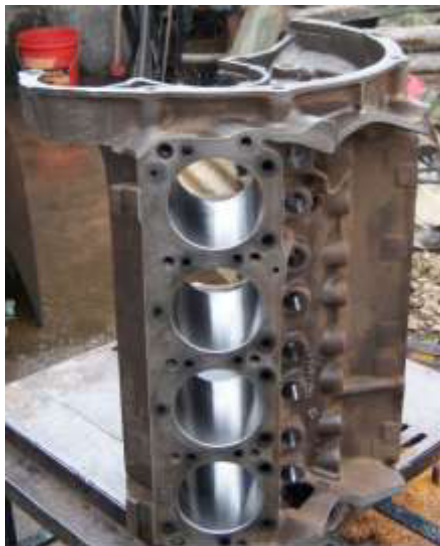
Figura 90 Bloque De Cilindros “Después De La Reparación”
