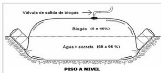
**Figura 5: Biodigestor Salchicha**
