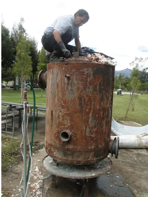
**Figura 8: Pared exterior del cuerpo del biorreactor**
