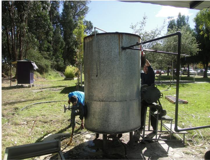
**Figura 11: Línea de purga como válvula de alivio de presión.**
