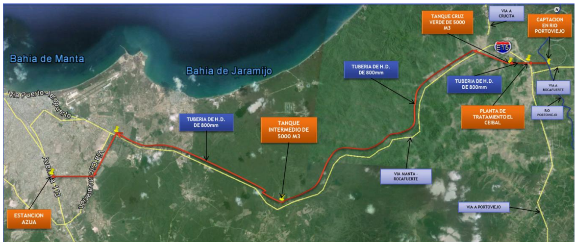
Figura 4 Acueducto El Ceibal – Azúa, longitud 31 Km
