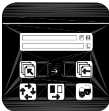
Figura 93. Sensor Siemens SONO 3100, botones y pantalla de configuración
