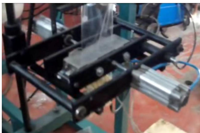
Figura 22 Sistema de Arrastre más Sellado
