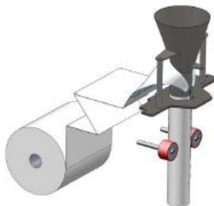
Figura21 Rodillos incorporados al cuello formador
