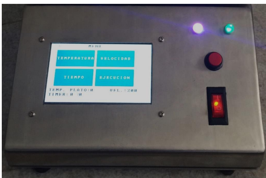
Figura 4.6. Panel frontal de control del equipo Hot-Plate
