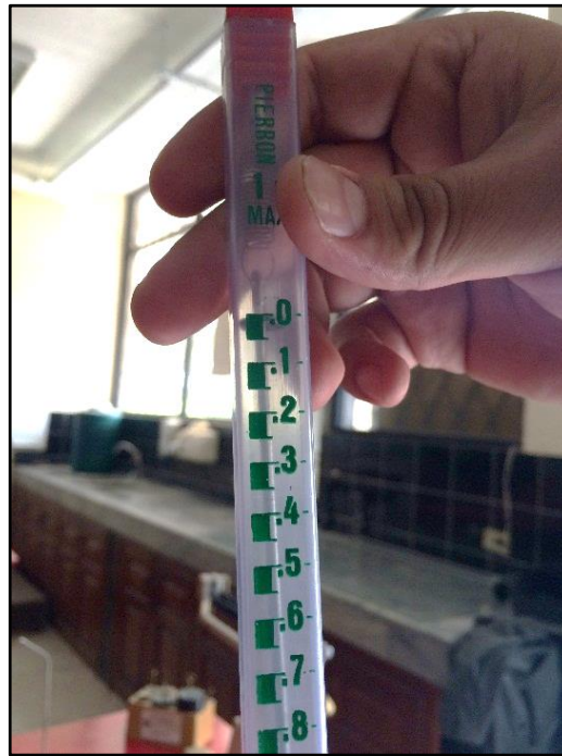
Figura 3.70. Encerar al dinamómetro.
