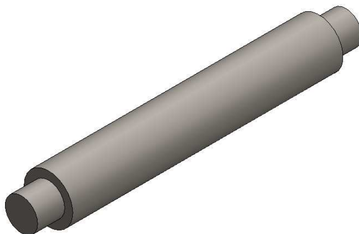
Figura 38. Diseño del acople para las fresas de moldurado
