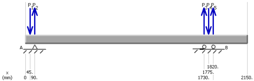
Figura 89. Distribución de fuerzas en el eje para el plano "XZ"
