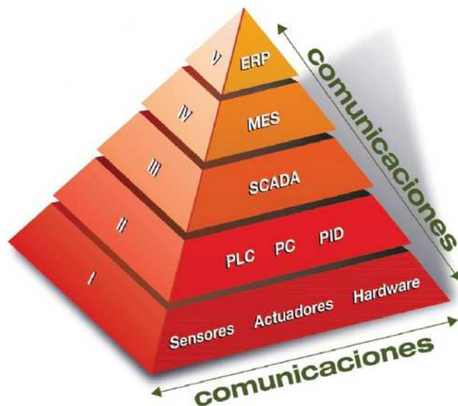
Figura 125. Pirámide de Automatización
