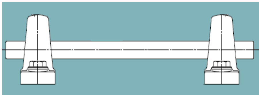
Figura 107. Disposición de las chumaceras con respecto al eje
