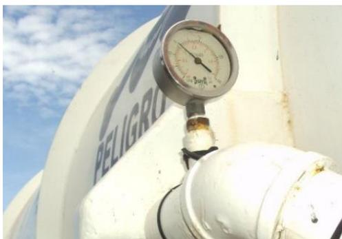
**Figura 62.** Vacuómetro instalado en las líneas de un camión de vacío
