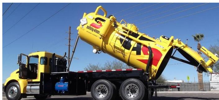
**Figura 58.** Método de descarga de un camión de vacío
