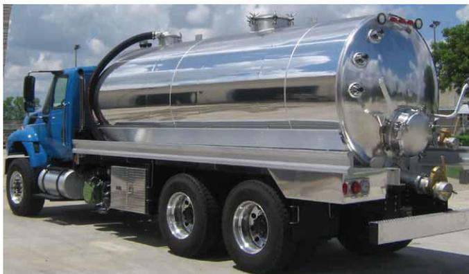
**Figura 59.** Camión de vacío con mirillas de inspección
