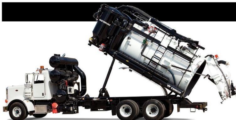
**Figura 4.** Camión de vacío fabricado por CUSCO con el método de descarga por gravedad
