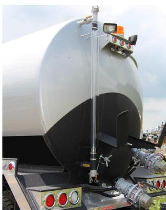
**Figura 60.** Camión de vacío con tubo de medición
