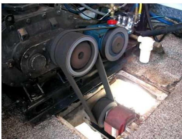
**Figura 51.** Camión de vacío accionado por correas
