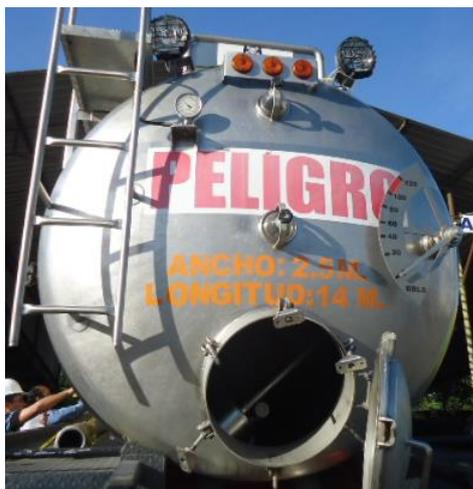
**Figura 61.** Camión de vacío con flotador
