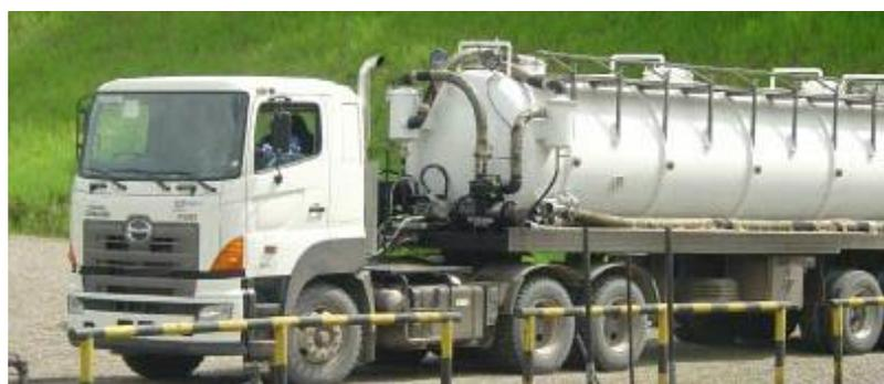
**Figura 3.** Camión de vacío fabricado en el Ecuador
