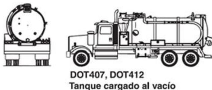
**Figura 11.** Camión simple utilizado en un tanque cargado al vacío
