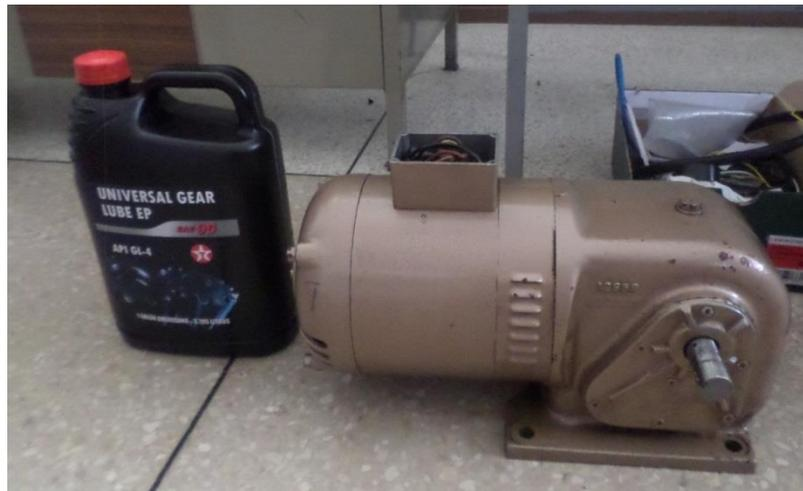
Figura 4.5 Cambio de lubricante
