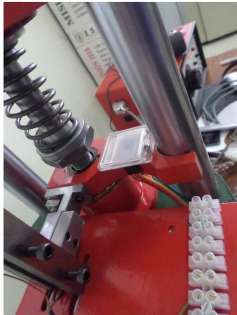
Figura 4.9 Protecciones sensores
