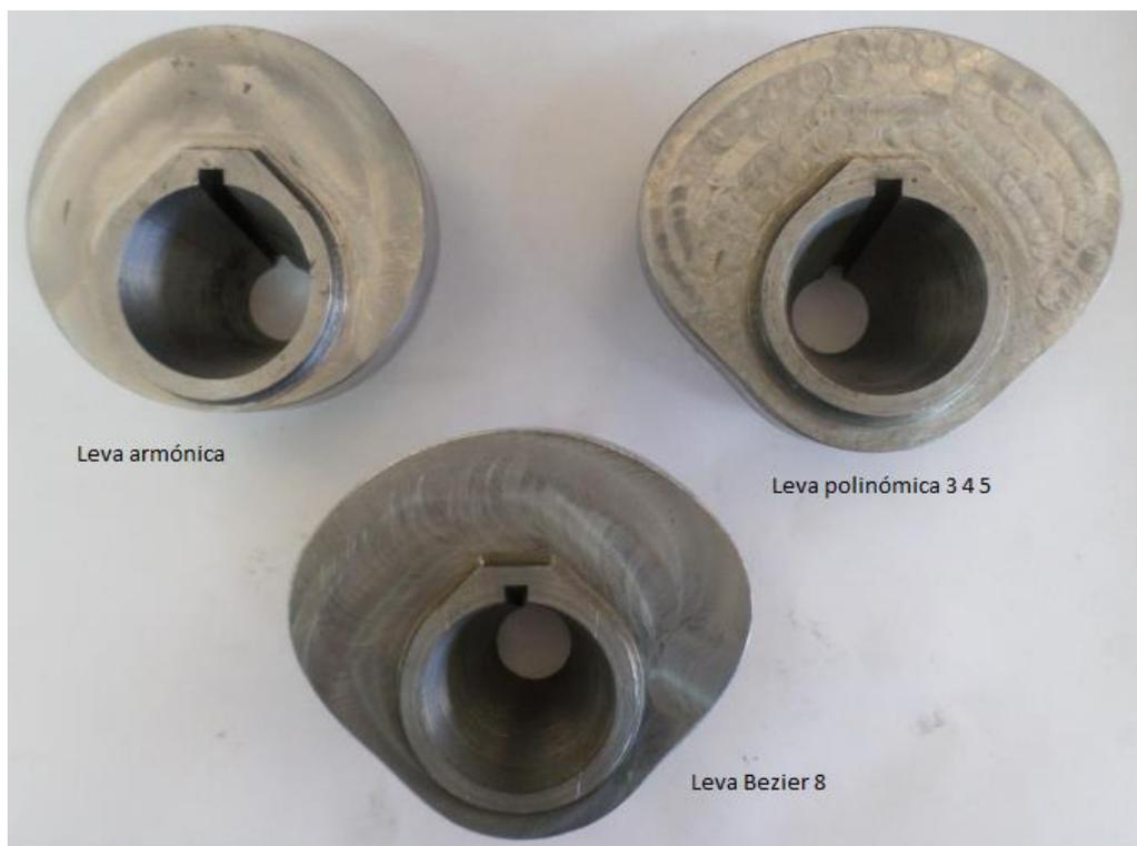
Figura 3.72 Vista posterior levas manufacturadas
