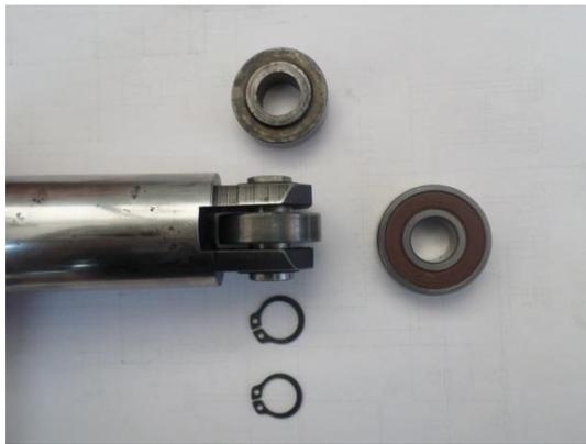
Figura 4.10 Reemplazo de rodillo
