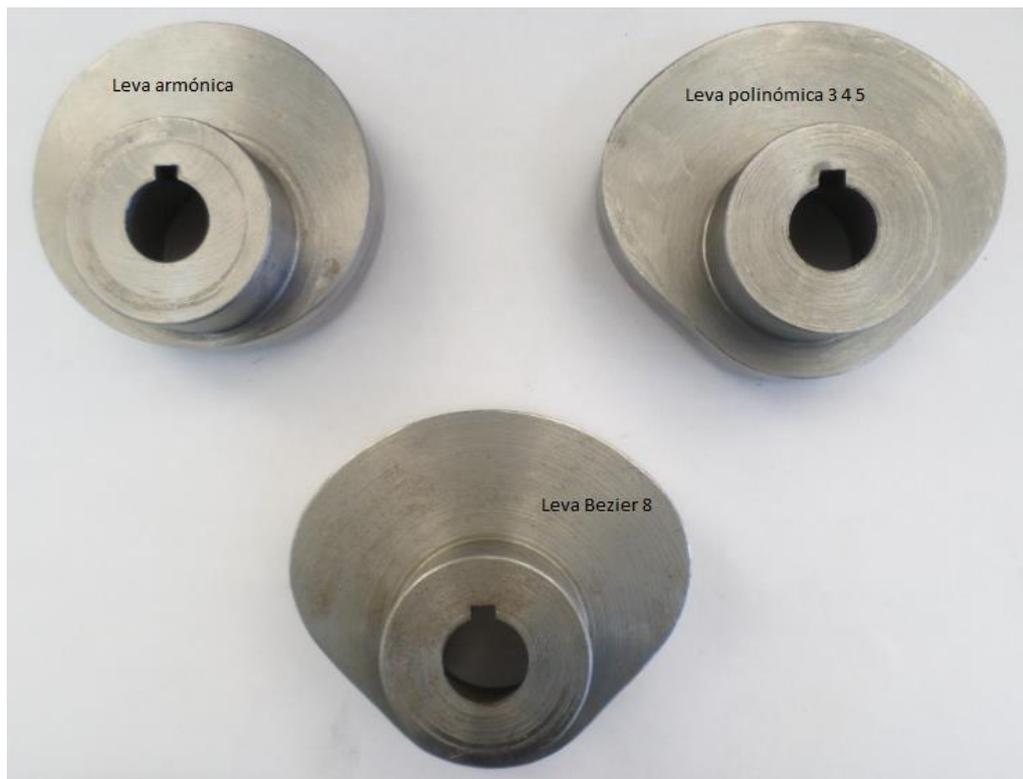
Figura 3.71 Vista frontal levas manufacturadas
