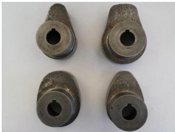
Figura 3.45 Levas provistas por el equipo Tecquipment TM21 062
