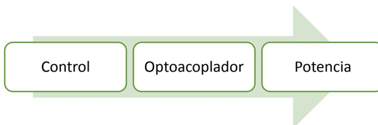
El optoacoplador elegido para el proyecto es el 4N25 de ST Microelectronics.
