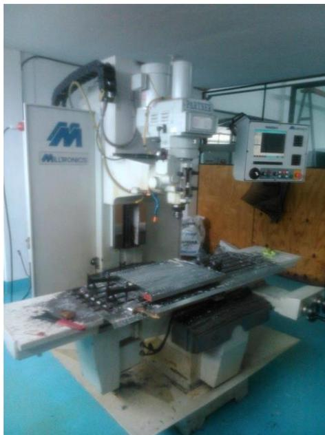
Figura 3.57 Fresadora CNC Milltronics
