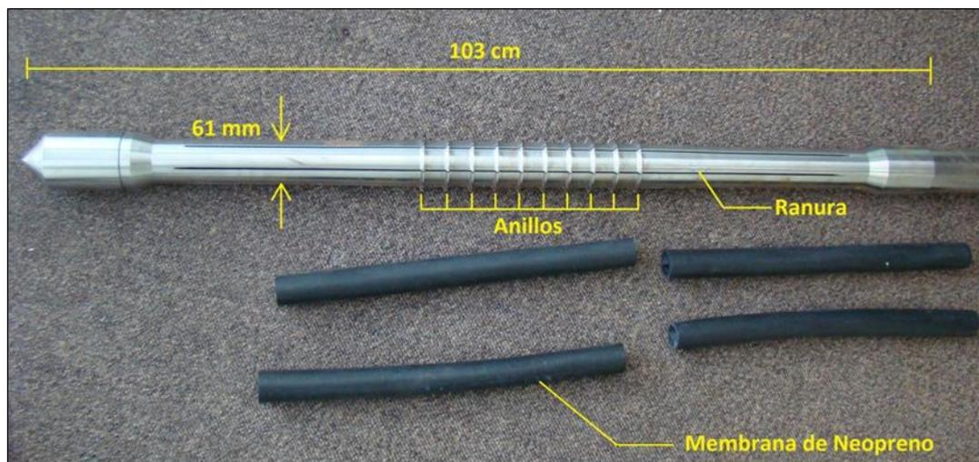
**Figura 3.2.** Sonda del ficómetro
