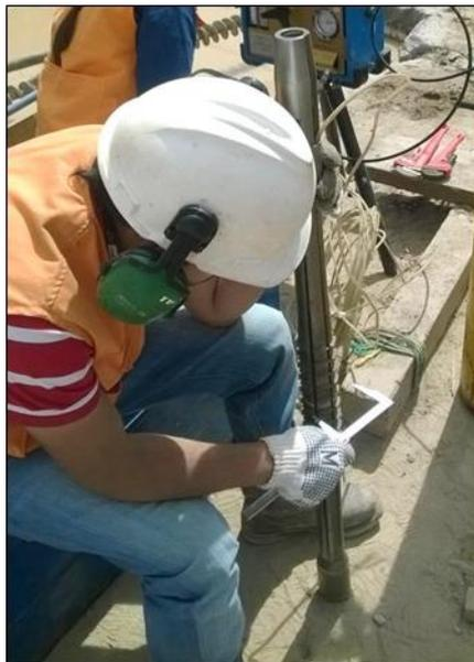
**Figura 3.11.** Medición del diámetro de la sonda del ficómetro
