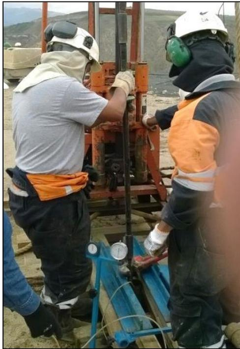
**Figura 3.13.** Colocación de la sonda del ficómetro
