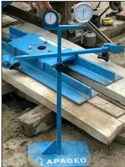
**Figura 3.7.** Sistema de medición de movimientos verticales
