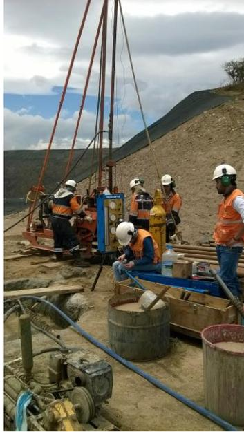
**Figura 6.1.** Ensayo Ficómetro en el Sito de Investigación 3
