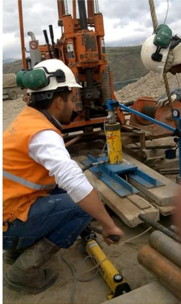
**Figura 6.7.** Proceso de extracción de la sonda mediante el gato hidráulico, Sitio de Investigación 3.
