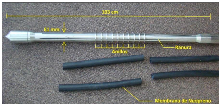
**Figura 2.9.**Sonda de ficómetro
