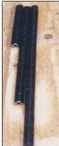
**Figura 3.4.** Tubería de perforación
