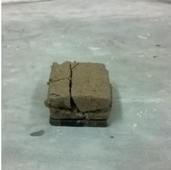
**Figura 6.15.** Falla de la muestra en Ensayo de Corte Directo
