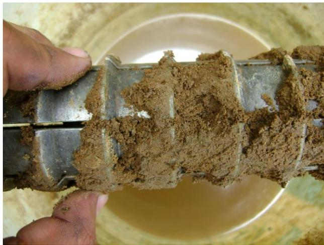
**Figura 6.8.** Material que queda entre los dientes anulares de la sonda, Sitio de Investigación 3.
