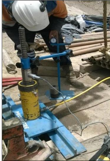
**Figura 3.15.** Colocación de la celda de carga, gato hidráulico y el trípode
