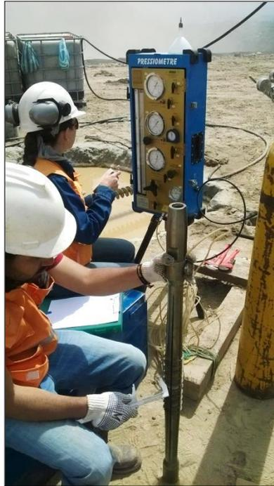
**Figura 3.10.** Calibración del equipo ficómetro
