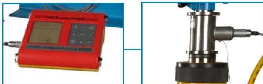
**Figura 3.16.** Calibrador dinamométrico para medir la fuerza de tracción T
