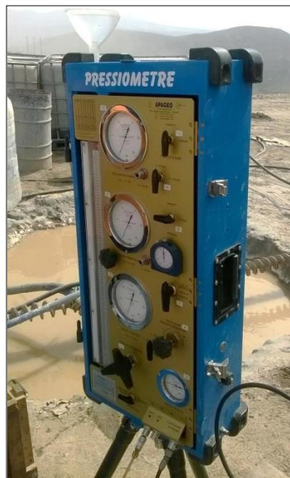
**Figura 2.10.** Unidad de Control de Presiones y Volúmenes
