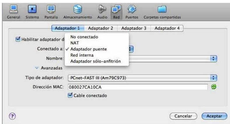
**Figura 23 Pantalla configuración red Virtual Box**
