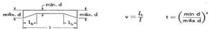
GRAFICA 1. VALORES DEL PARAMETRO ELASTICO \alpha , para cualquier extremo de miembros simétricos con cartelas rectas
