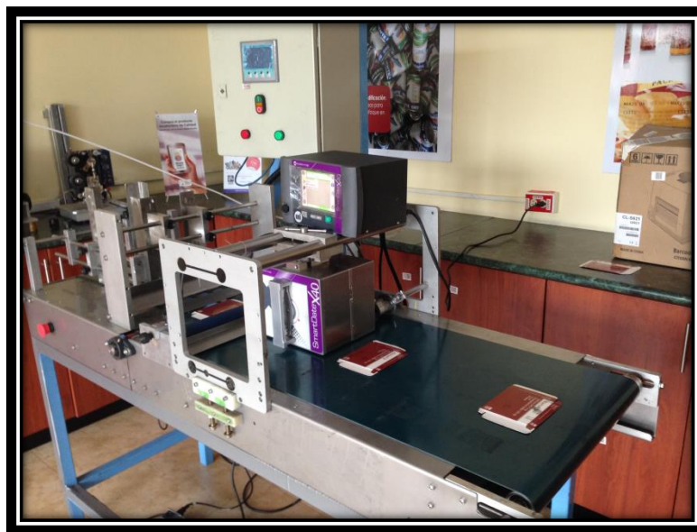
FIGURA 77 DISPENSADO DE EMPAQUES VACIOS
