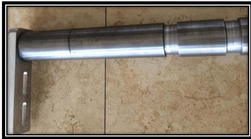
FIGURA 52 Rodillo no motriz de arrastre
