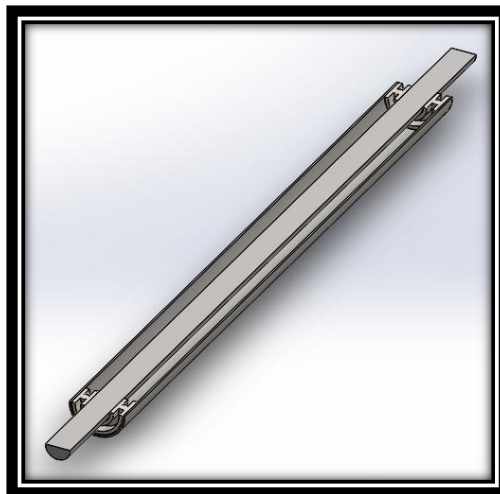
FIGURA 28 Vista en corte de rodillo no motriz
