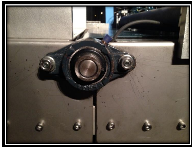
FIGURA 58 Montaje de chumacera
