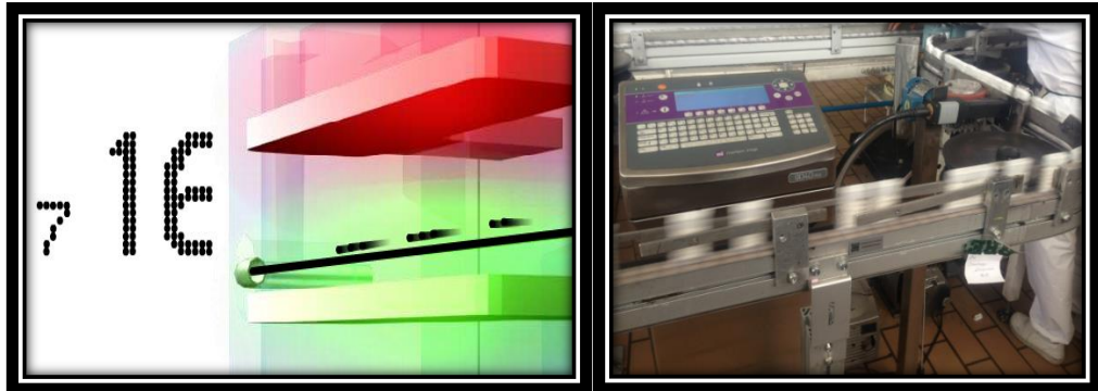
FIGURA 12 Impresión matricial equipos inkjet/Codificador 9040 Markem-Imaje en producción
