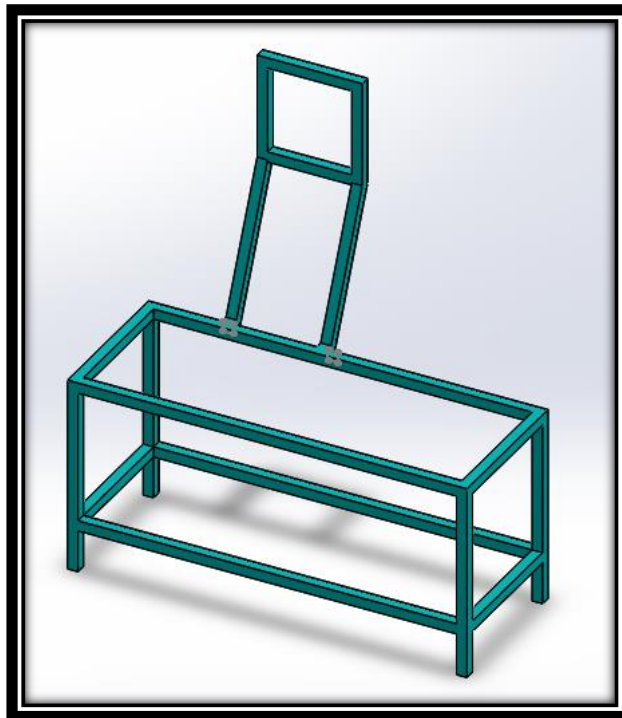
FIGURA 34 Diseño de soporte de equipo en Solidworks
