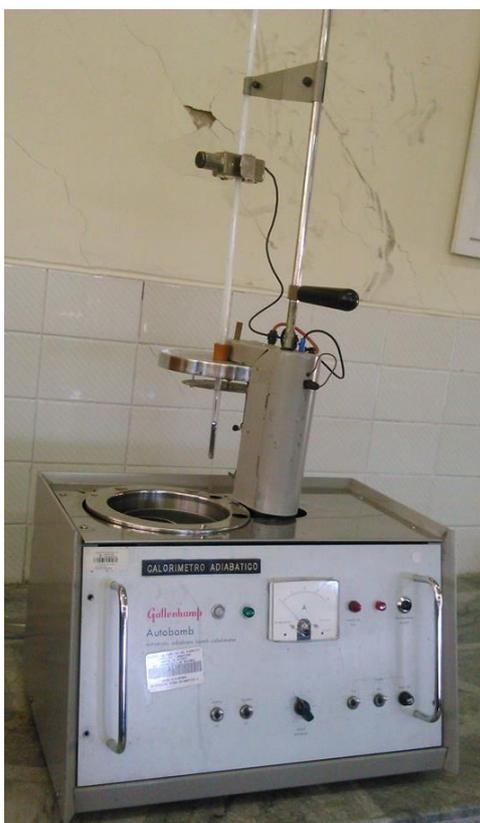
**Figura 109. Bomba Calorimétrica Adiabática de Gallenkam**
