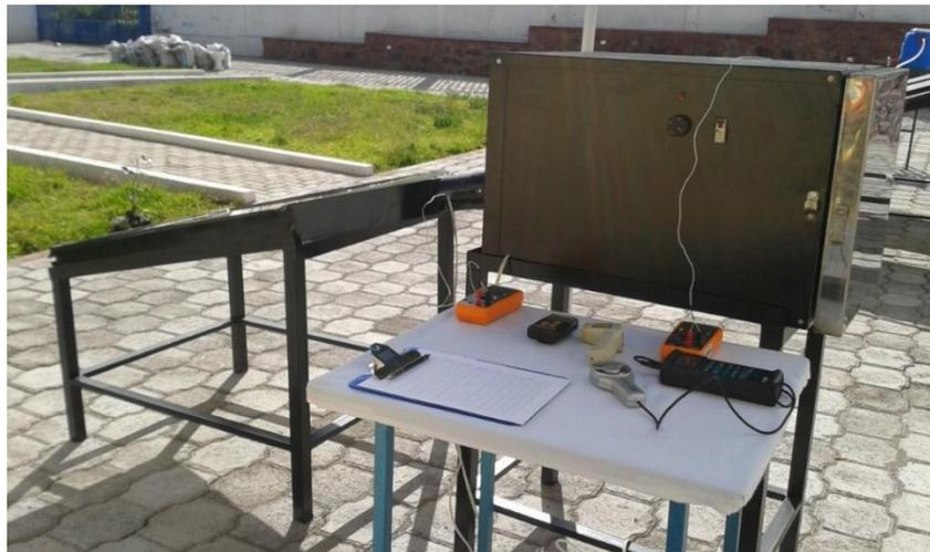
**Figura 84. Pruebas de secado en el horno híbrido.**
