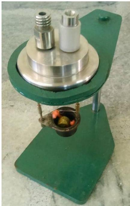
Figura 114. Ensamblaje de la bomba colocación del cordel al fino conductor.
