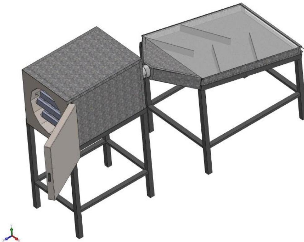
Figura 35. Acoplamiento de horno y colector solar.
