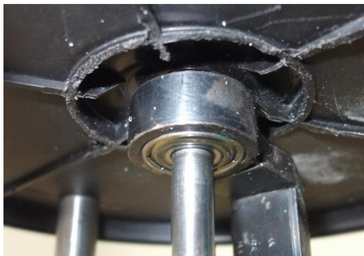
Figura 31. Ubicación de rodamiento para evitar fricción y vibración del eje del motor
