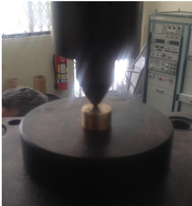
Figura 13: Ensayo de dureza a la probeta de bronce
