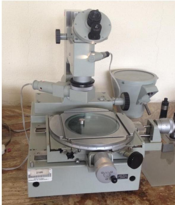
Figura 15: Microscopio de Herramientas de apreciación 0,001mm
