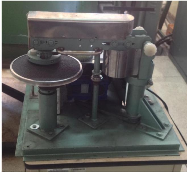
Figura 16: Máquina de desbaste
