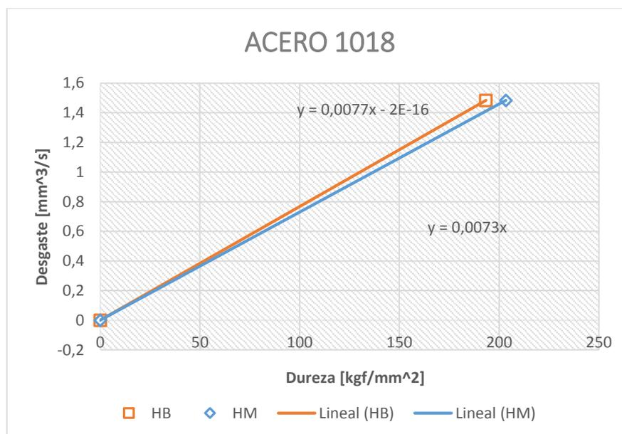
Figura 36: Gráfica Dureza vs Desgaste del Acero 1018
