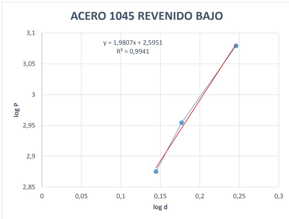
Figura 22: Grafica log d vs log P del Acero 1045 Revenido Bajo
