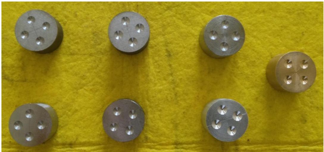
Figura 17: Probetas luego de realizado las perforaciones parciales tipo avellanado
