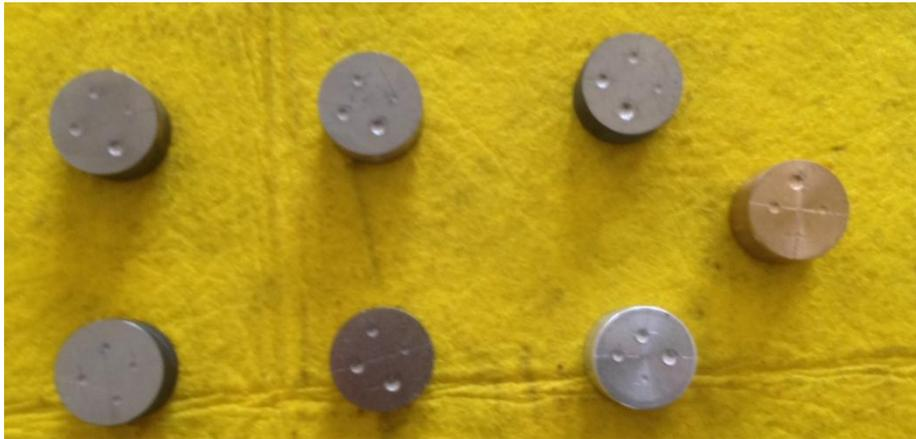
Figura 14: Probetas después de realizado el ensayo de dureza con las diferentes cargas
