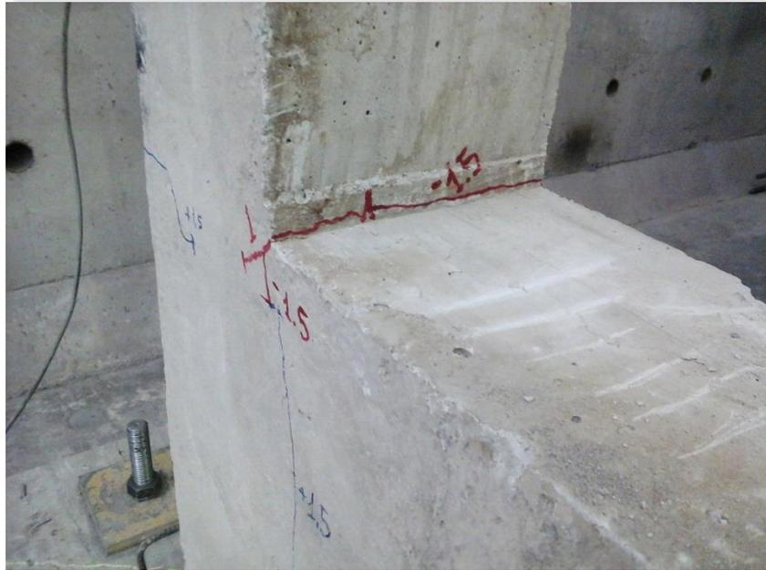
**Figura 221. CICLO 5. Carga  $\leftarrow$  1.530 T,  $\Delta$  3.42 mm**
