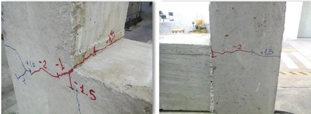
Figura 223. CICLO 6. Carga  $\leftarrow$  2.003 T,  $\Delta$  5.66 mm -Falla en la unión-
