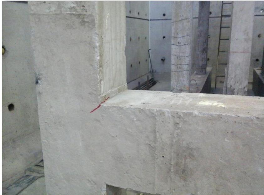
**Figura 219. CICLO 4. Carga  $\rightarrow$  1.017 T,  $\Delta$  2.07 mm**
