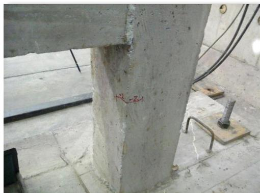
Figura 224. CICLO 6. Carga  $\leftarrow$  2.003 T,  $\Delta$  5.66 mm -Columna inferior-
