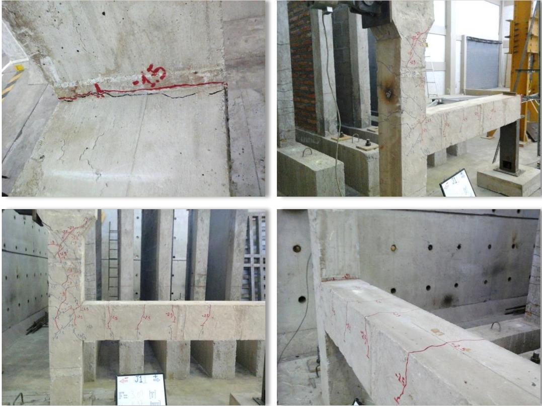
**Figura 227. CICLO 7. Carga  $\leftarrow$ 2.530 T,  $\Delta$  9.44 mm**
