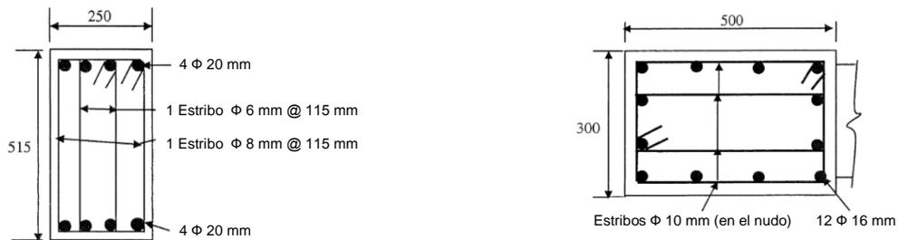
Figura 139. Sección transversal de viga y columna
