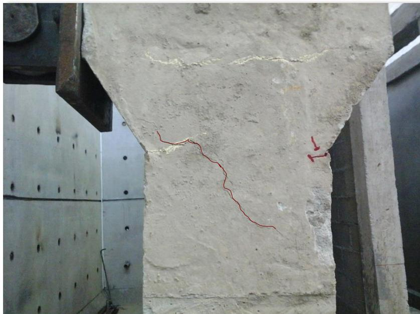
**CICLO 6. Carga  $\rightarrow$  1.757 T –Fisura del cabezal-**
