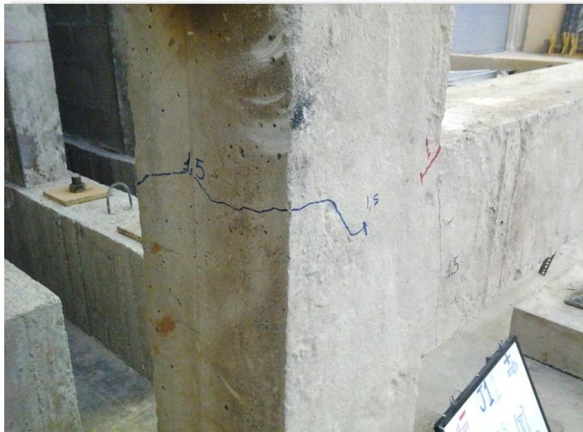
**Figura 220. CICLO 5. Carga  $\rightarrow$  1.523 T,  $\Delta$  3.71 mm**
