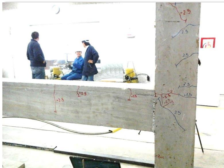
**Figura 228. CICLO 8. Carga  $\rightarrow$ 3.036 T,  $\Delta$  14.60 mm**
