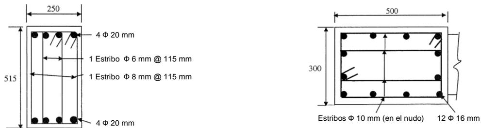
**Figura 141. Sección transversal de viga y columna**
