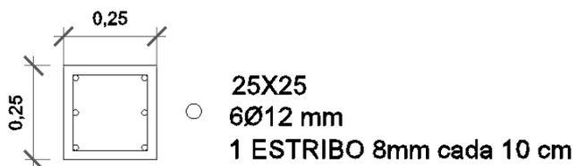
Figura 202. Refuerzo longitudinal y transversal de columna
