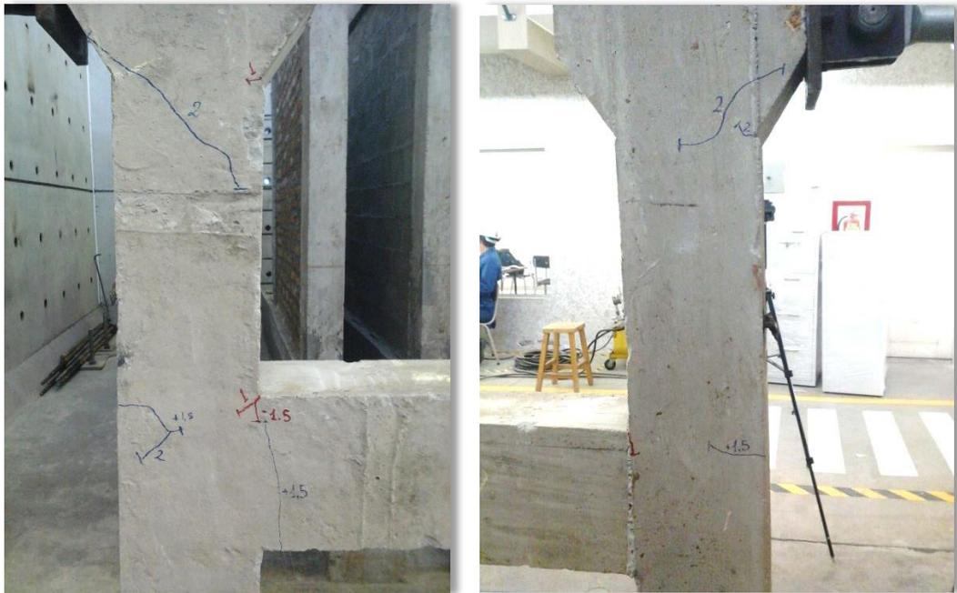
Figura 222. CICLO 6. Carga  $\rightarrow$  2.017 T,  $\Delta$  6.41 mm
