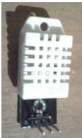
Figura 6: Sensor DHT22
