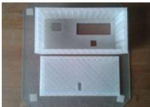
**Figura 51: Caja impresa del módulo base.**
