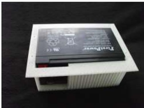
**Figura 39: estructura plástica para batería.**
