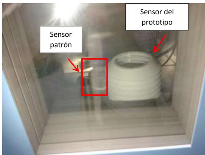
**Figura 57: Sensor de humedad y sensor patrón.**
