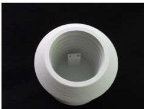
**Figura 35: Protección del sensor de humedad y sensor de temperatura**
