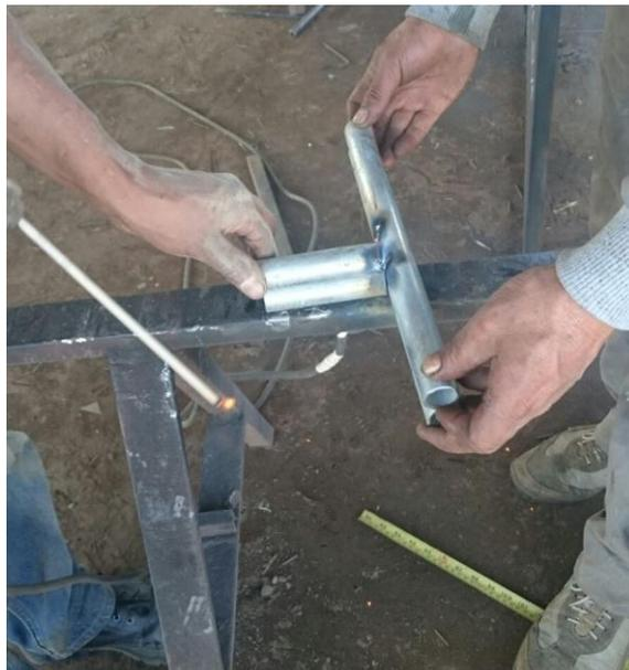
Figura 49: Soldadura soporte de servomotor
