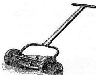
Figura 12: Cortadora de rodillo y palas cortantes
