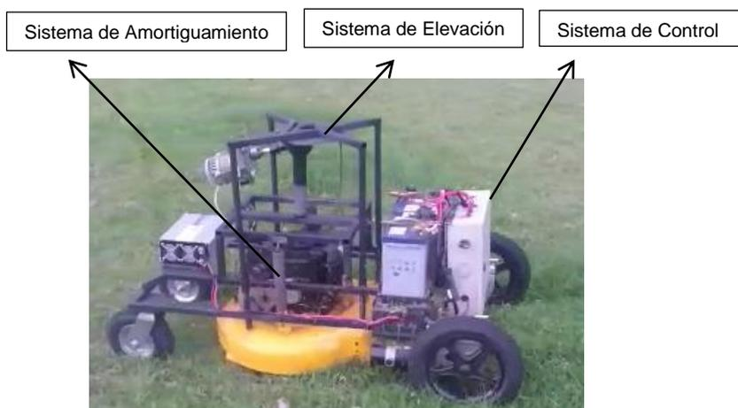
Figura 55: Sistemas completos de la cortadora de césped
