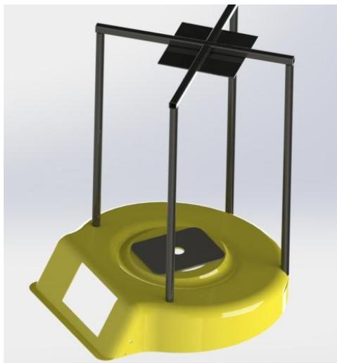
Figura 52: Diseño CAD de base para motor de combustión y guía móvil
