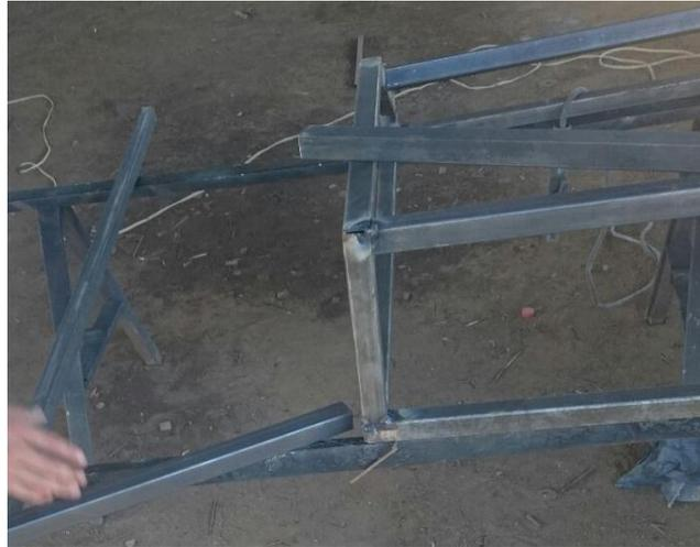
Figura 48: Manufactura de la estructura base
