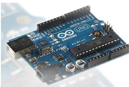
Figura 16: Placa Arduino Uno
