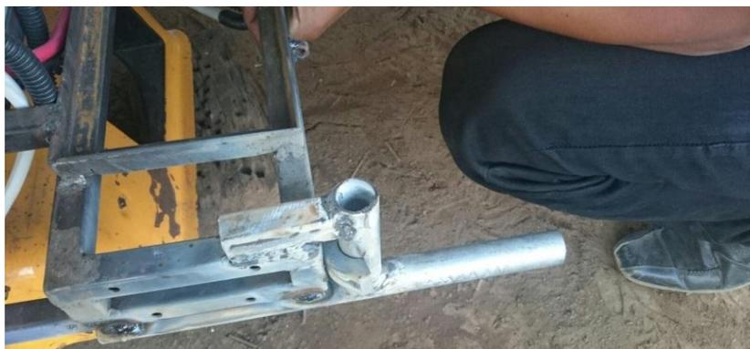
Figura 50: Soporte de servomotor final
