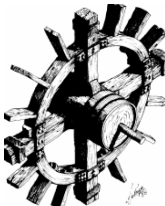
Figura 1. Rueda Hidráulica Romana
