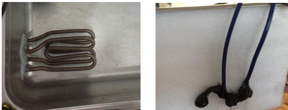
Figura 26. NIQUELINAS 2400 W INSTALADAS EN BANDEJA INTERNA
