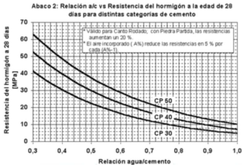
Figura 11. Resistencia del hormigón versus relación agua cemento.
