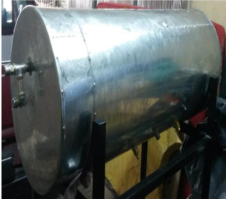
**Figura 55.** Cubierta acero galvanizado
