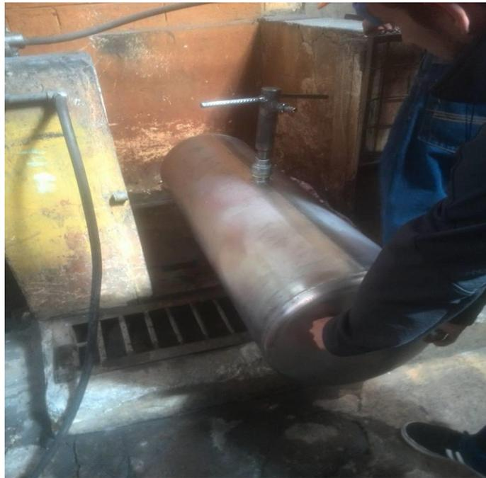
**Figura 72.** Colocación de Accesorios para entrada de presión
