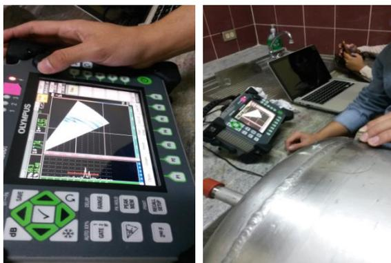
**Figura 69.** Procedimiento de Ultrasonido
