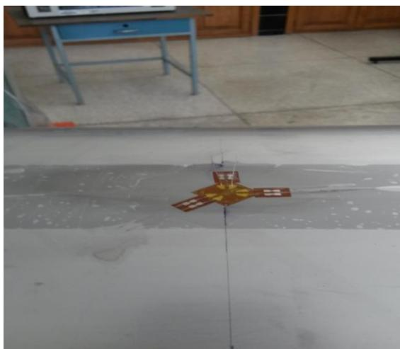
**Figura 59.**Colocación galgas en el acumulador
