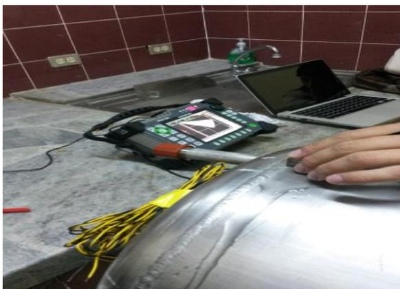
**Figura 68.** Colocación glicerina en la soldadura del acumulador
