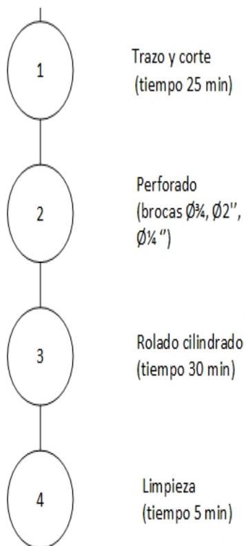
**Figura 45.** Fabricación carcasa acumulador
