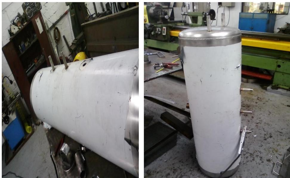
**Figura 54.** Soldadura Accesorios Acumulador
