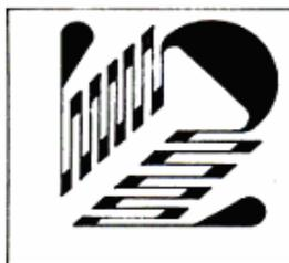
**Figura 33.**Esquema Galga Biaxial
