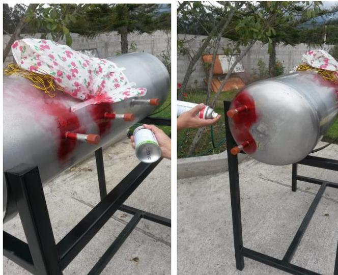
**Figura 63.** Aplicación Penetrante Accesorios Acumulador
