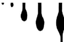
**Figura 18** Corrosión por picadura
