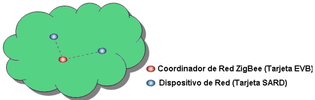
Figura 4.1 Topología de la Red ZigBee
