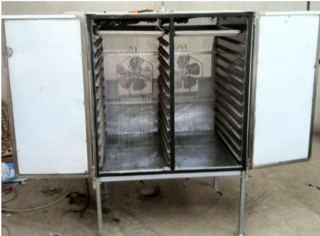
**Figura 55 Construcción Total Parte Mecánica de la Deshidratadora**
