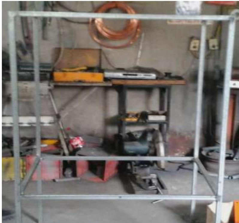
**Figura 28 Estructura Metálica Usada para la Deshidratadora**
