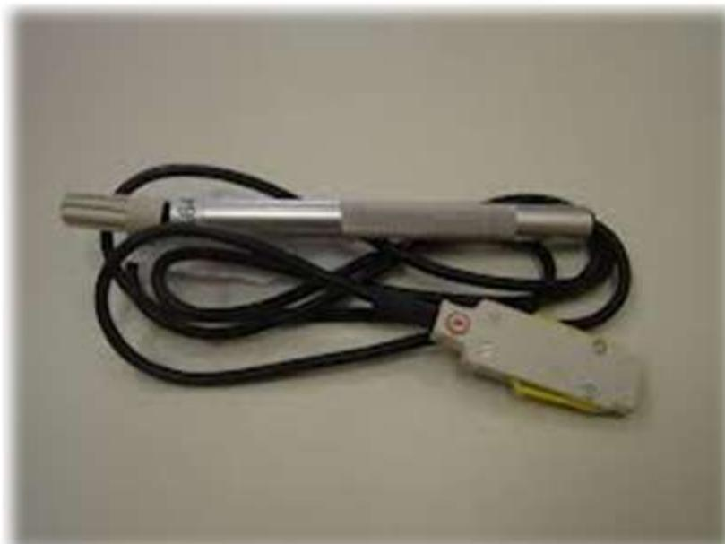
**Figura 12 Sensor de Humedad y Temperatura**
