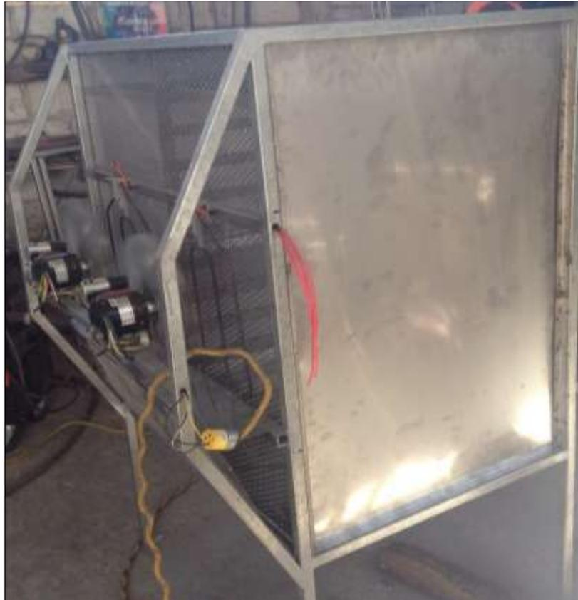
**Figura 48 Recubrimiento de la Cámara Interna con Acero Inox. 304**
