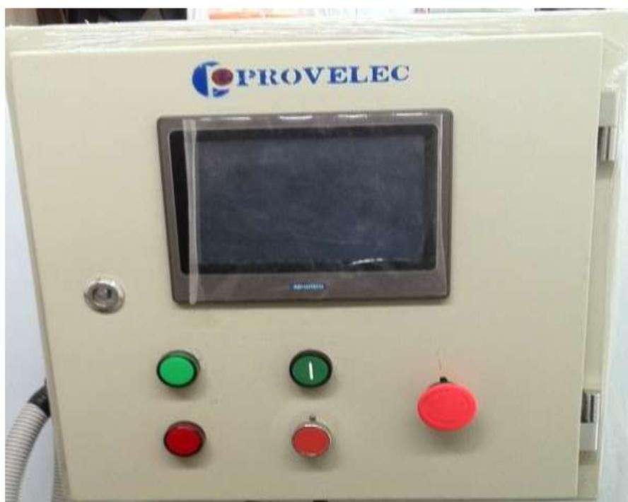
**Figura 59** Distribución de la Pantalla, Luces y Botones en el Tablero
