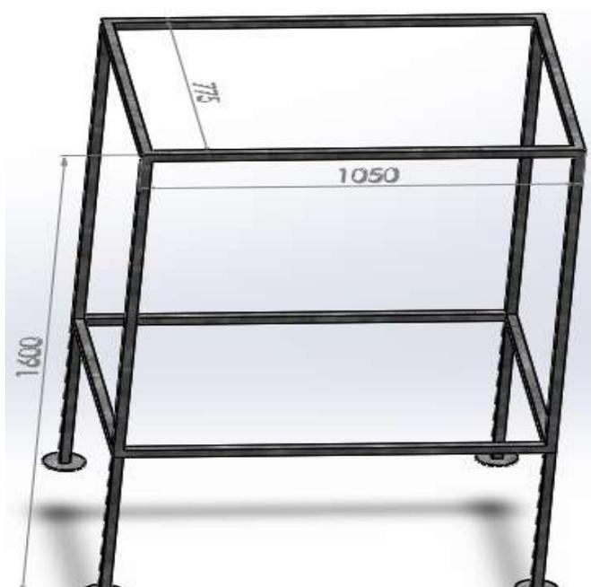
**Figura 45 Estructura Metálica de la parte Exterior del Horno**
