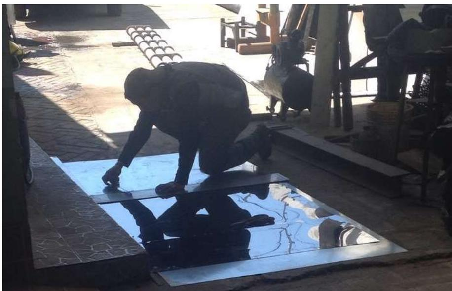
**Figura 47 Trazo y Corte de las Planchas de Acero Inoxidable**
