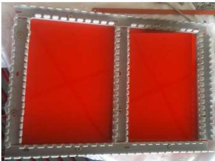
**Figura 56 Canaletas en Laterales del Tablero**
