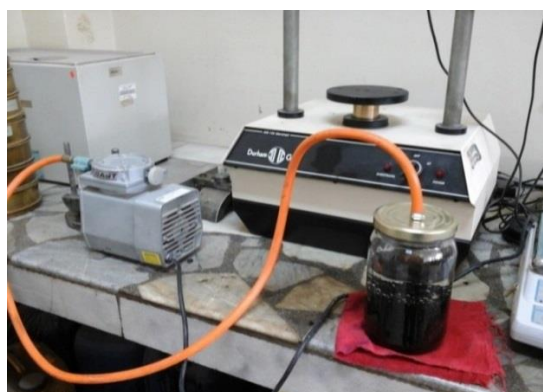
Figura 88. Proceso de extracción de Aire.
