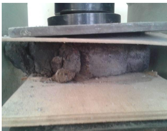
Figura 94. Falla en Adoquín ensayo.
