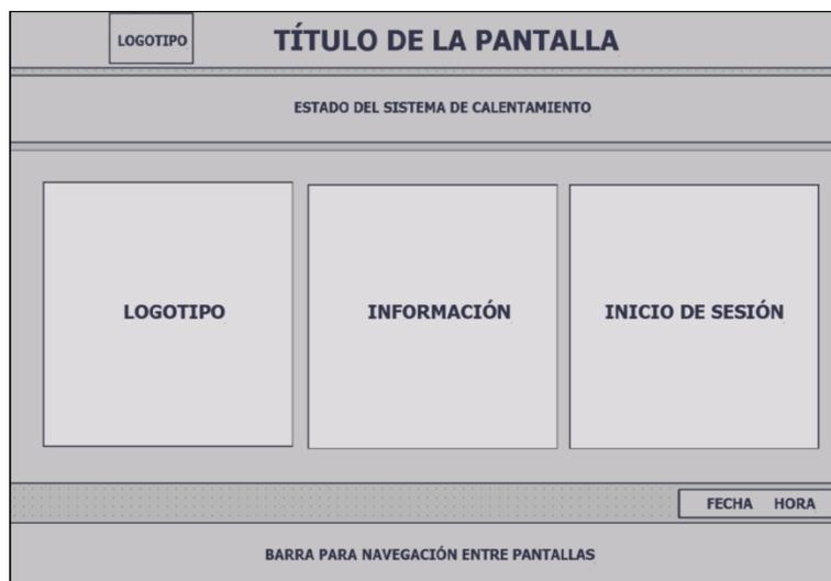
**Figura 31** Plantilla para diseño de HMI (Pantalla de inicio).
