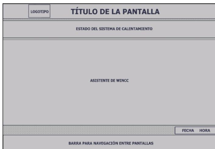
**Figura 33** Plantilla para diseño de HMI (Pantalla para alarmas, recetas, usuarios).
