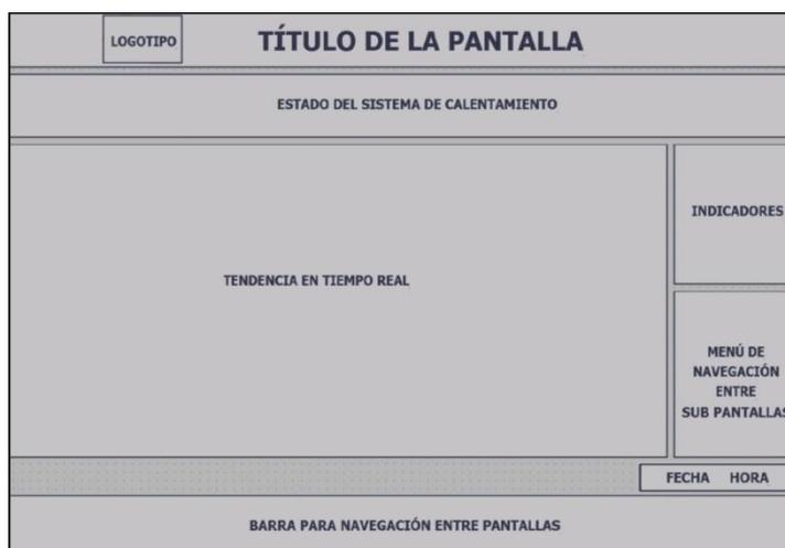
**Figura 34** Plantilla para diseño de HMI (Pantalla para tendencias en tiempo real).
