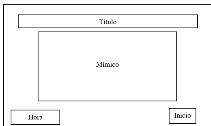
Figura 48. HMI ventana principal.
