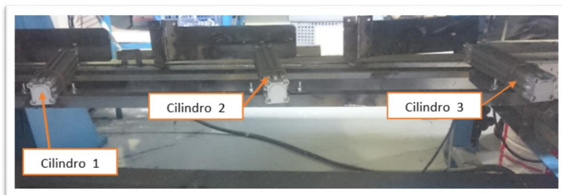
Figura 74. Montaje de los actuadores en la banda.
