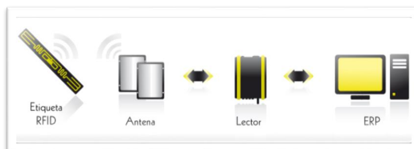
Figura 14. Elementos de un sistema de tecnología RFID.
