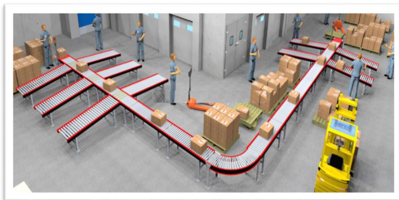
Figura 7. Sistema de clasificación automática por rodillos y gavetas. Fuente: (Atox, 2016).
