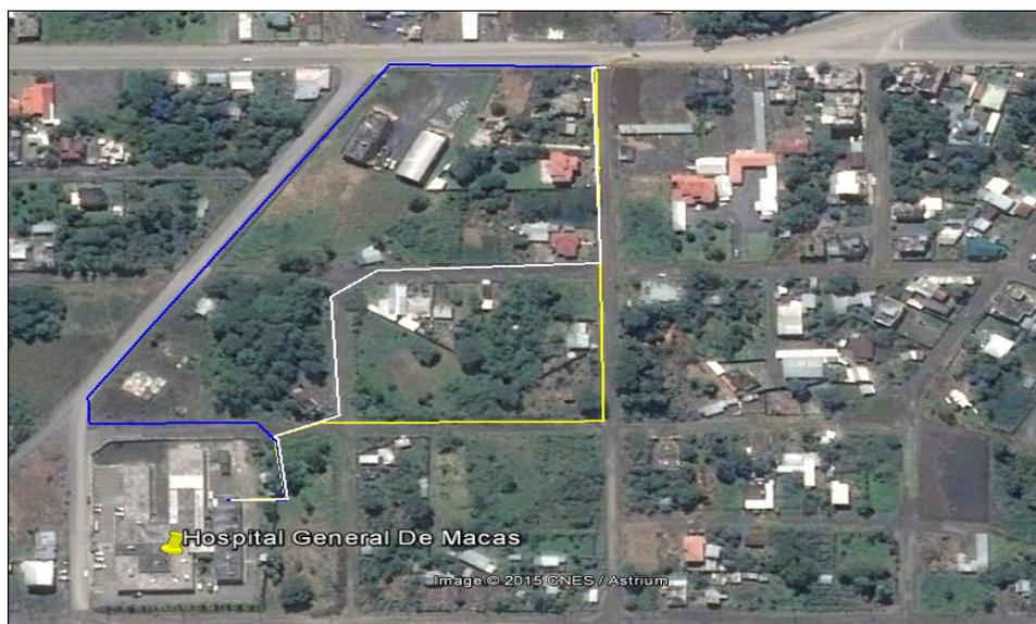
**Figura 28 Rutas de posible extensión del alimentador 2121 hasta el H.G.M**
