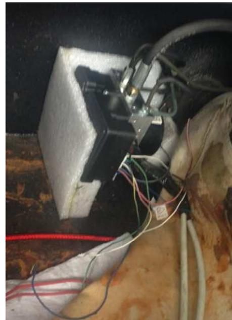
*Figura 43 Cuerpo de válvulas del ABS conectado*
