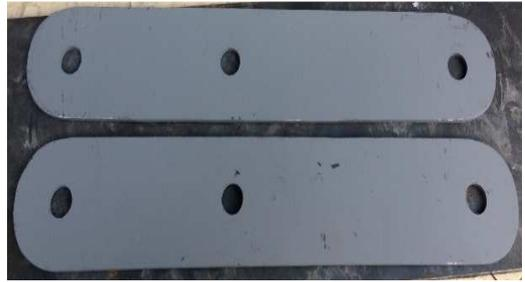
*Figura 34 Brazo de palanca*
