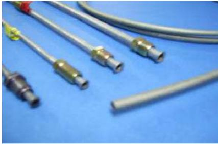
*Figura 20 Tubería de freno*
