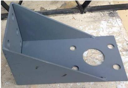
*Figura 32 Soporte de la bomba de freno*
