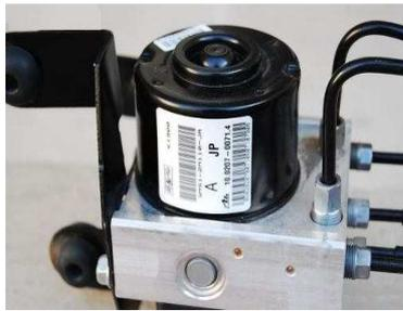
*Figura 21 Cuerpo de válvulas del ABS*
