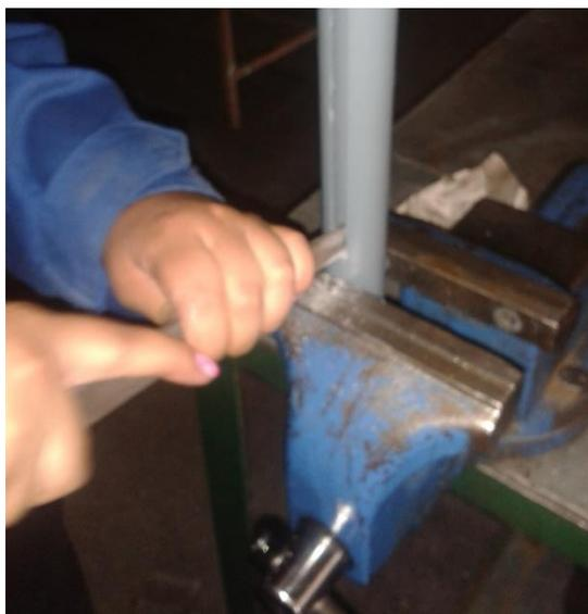
**Figura 86** Limado de la ranura de 8mm.
