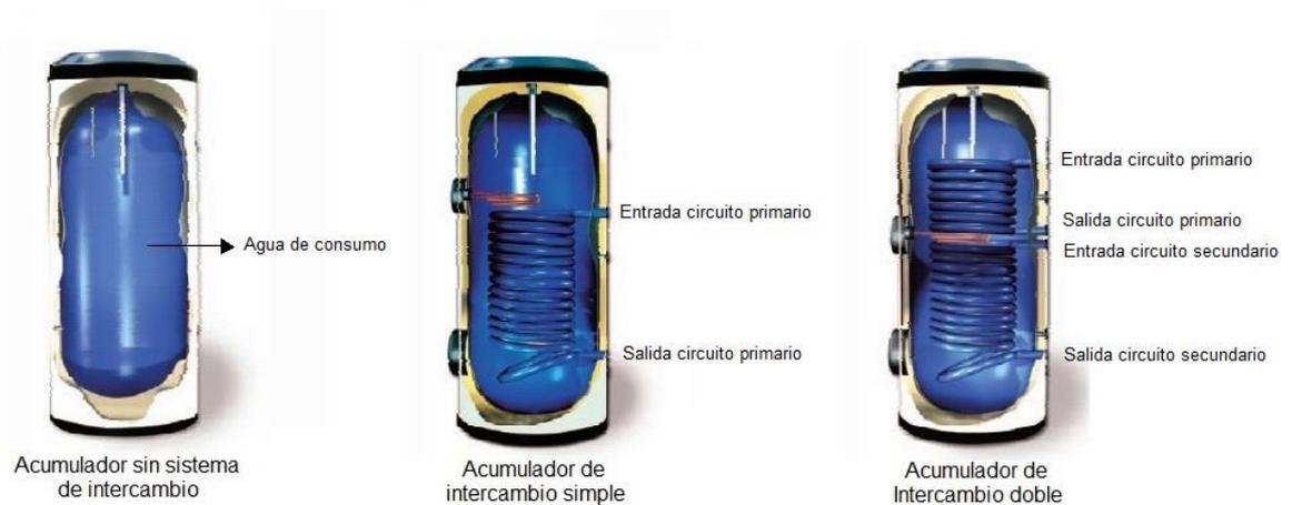
**Figura 18** Tipos de acumuladores según el sistema de intercambio.
