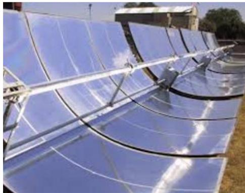
**Figura 14** Captador solar de concentración.
