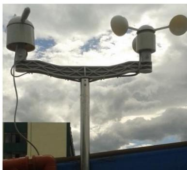
**Figura 106** Instalación de anemómetro y veleta.
