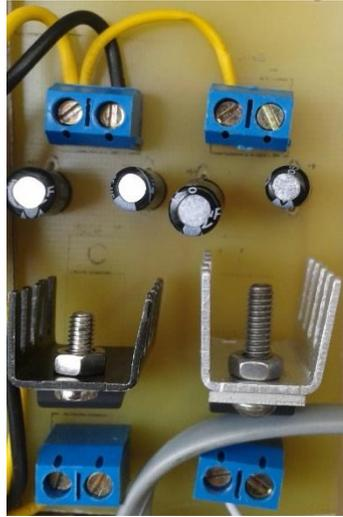
**Figura 112** Placa electrónica del módulo de alimentación.
