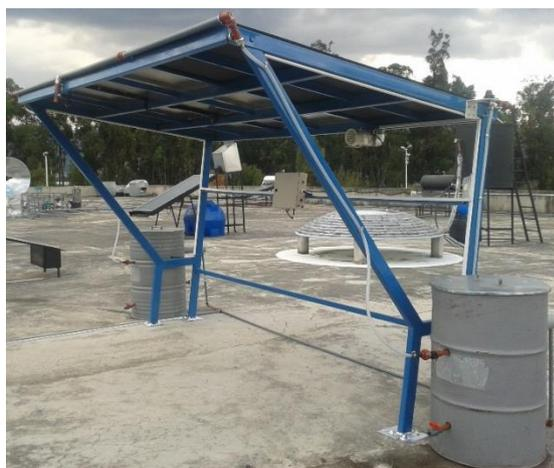
**Figura 81** Calentador de agua y calefactor de ambiente con colector de policarbonato alveolar 8mm.
