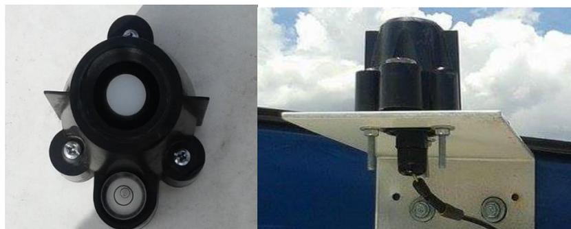
**Figura 105** Instalación del piranómetro.
