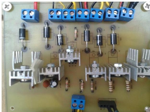
**Figura 111** Placa electrónica del módulo de potencia.
