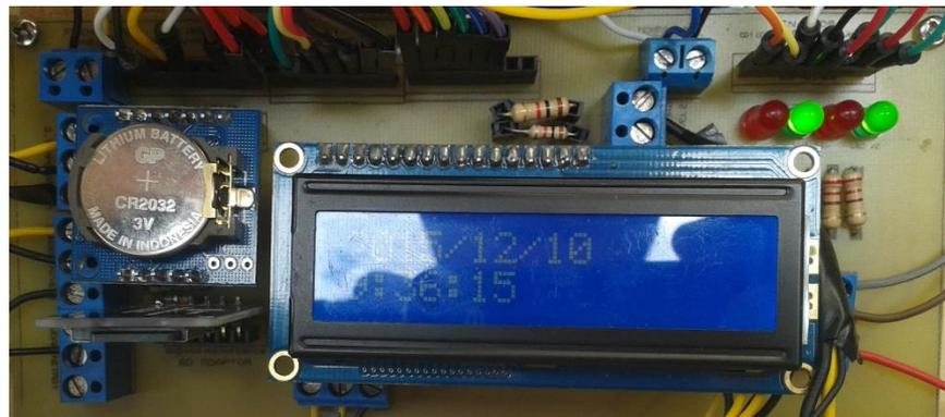
**Figura 113** Placa electrónica del módulo de control y adquisición de datos.
