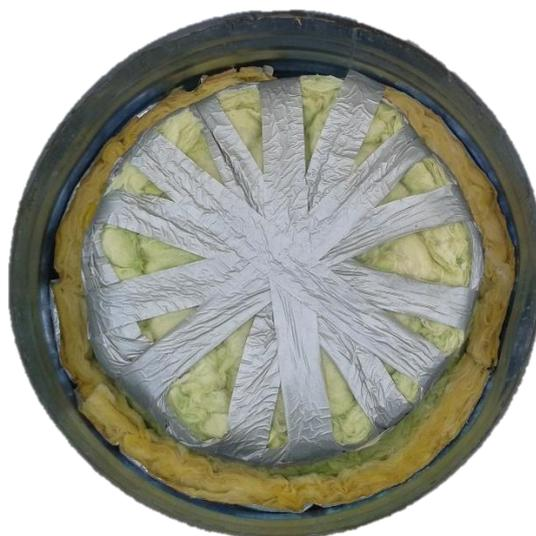
**Figura 94** Tanque de almacenamiento y aislamiento.
