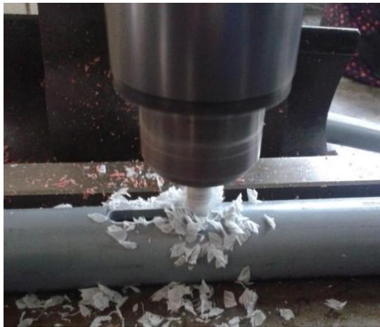
**Figura 85** Ranurado de 8mm x 98mm.
