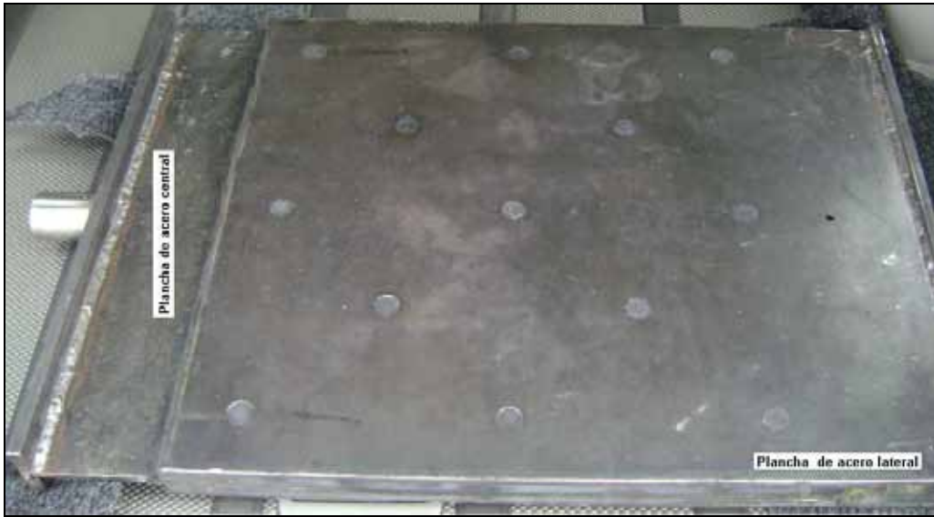
Figura 1.9 Prototipo del Muro Visco Elástico.
