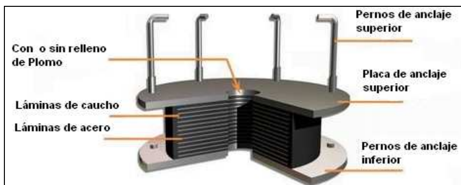
Figura 3.1 Detalle de un aislador elastomérico.
