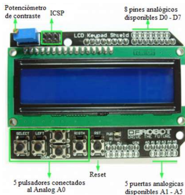
Figura 3 Partes constitutivas del SHIELD LCD ARDUINO
