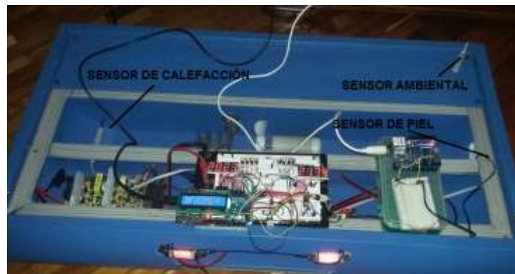
Figura 33 Colocación de los sensores en la Incubadora Neonatal
