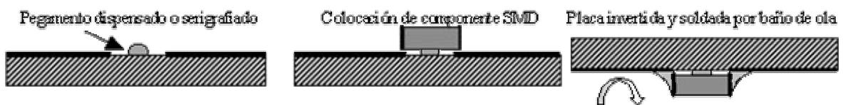
Figura. 2. SMT empleando la técnica de soldadura por “baño de ola”
