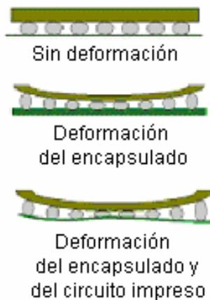
**Figura. 7.9.** Comparación de los efectos de cambio de forma del encapsulado y de la placa.
