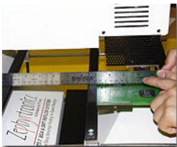
Cuenta con dos controles independientes de ajustes que separados proveen 360° de rotación independiente de la sonda de succión, ayudando a alinear y colocar con precisión los BGAs de Fine Pitch. Abarca fácilmente el montaje de una PCB de hasta 52[cm] de profundidad y sin límite de largo.
