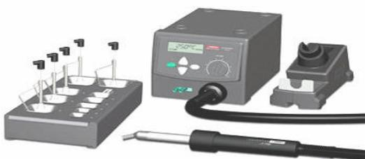
especialmente integrados tipo QFP y PLCC. La estación incorpora una bomba generadora de aire caliente, con control electrónico sobre la temperatura y el caudal del aire. Su sistema realiza la desoldadura de manera limpia y rápida, protegiendo el resto de los componentes y
