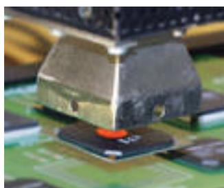
El "Eje-Z" levanta y baja la zona de calor hacia el dispositivo en cuestión en el sustrato; el "Eje-Y" retrae y devuelve la zona de calor antes y después del reflujo, permitiéndole al operador alinear, aplicar flujo, preparar, limpiar, e inspeccionar sin que la zona de calor interfiera.
